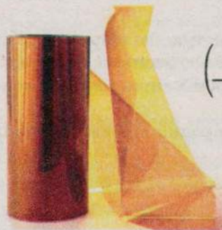
Мал. 12.8. Прозорі плівки, які отримують з розплавів або розчинів поліамідів. Зносостійкі, міцні на злам, стійкі до лугів, розчинників, масел. Застосовують для упаковки харчових продуктів (жирів зокрема), як оболонки для ковбас, електроізоляційний матеріал тощо
