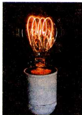
Рис. 17.4. Нагрівальний елемент електричної лампи розжарювання виготовляють із вольфраму, температура плавлення якого 3387 °С. Нагріваючись до температури 3000 °С, тонкий вольфрамовий волосок починає яскраво світитися
