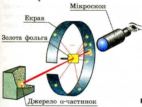
Рис. 31.4. Схема дослід з вивчення будови атома
