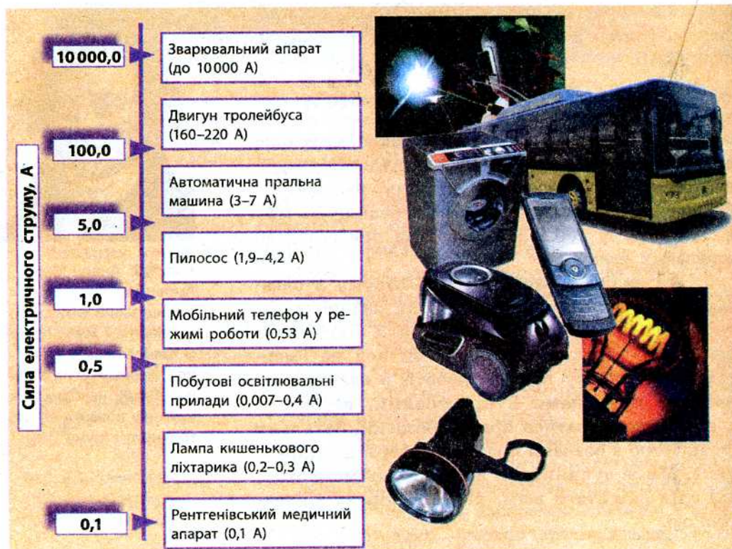
Рис. 9.4. Значення сили струму в деяких електротехнічних пристроях
