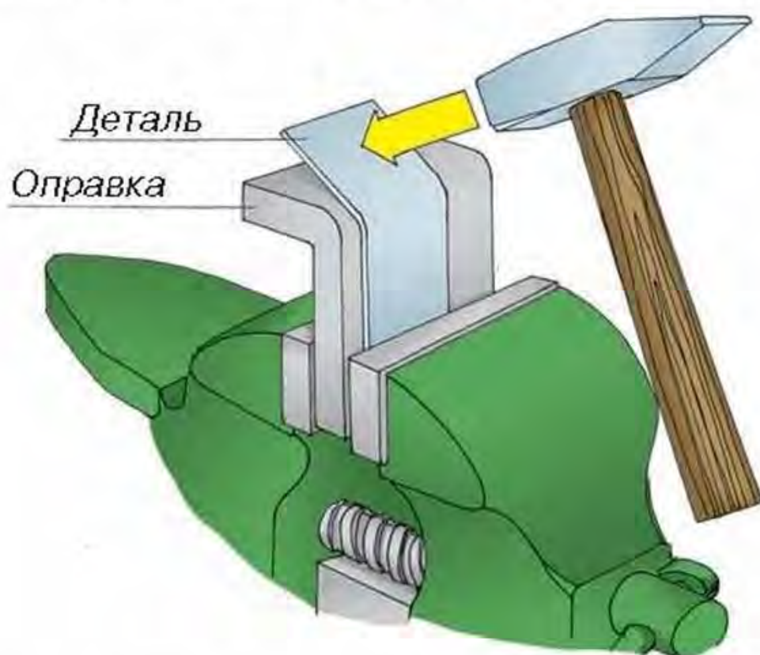
Мал. 95. Гнуття заготовки в лещатах по оправці
