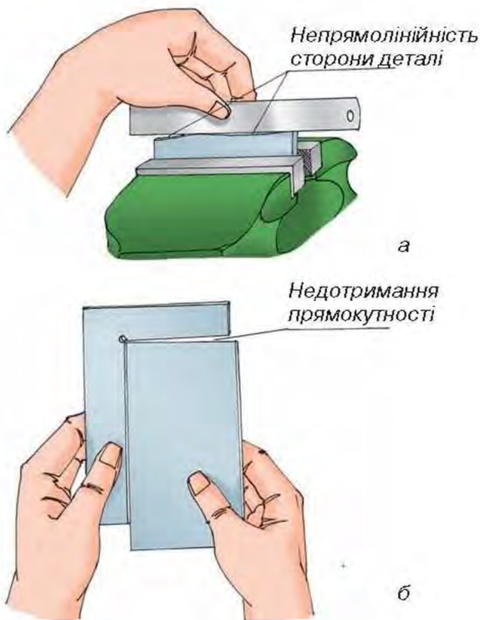
Мал. 88. Контроль обпилюваної поверхні за допомогою лінійки (а) та кутника (б)
