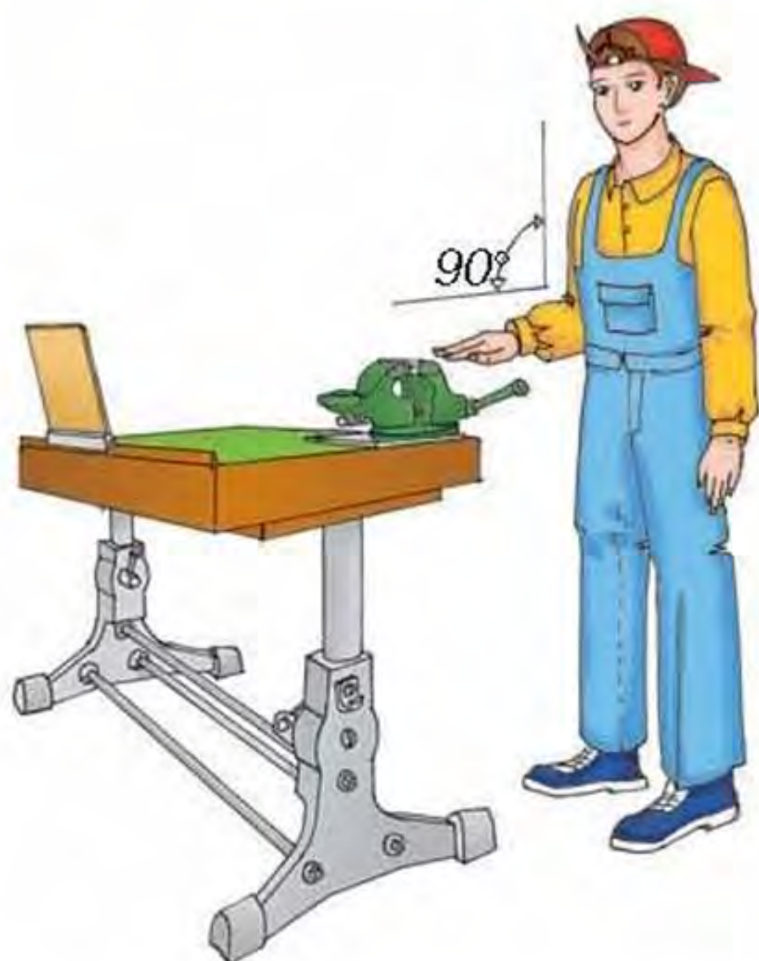
Мал. 11. Перевірка правильності вибору висоти слюсарного верстака
