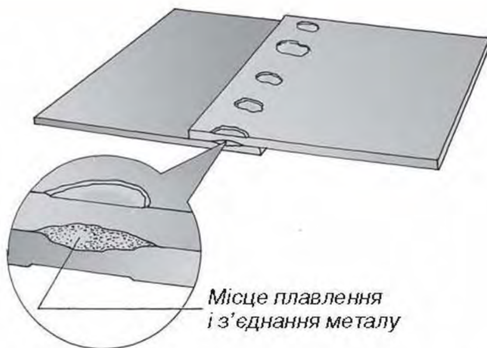
Мал. 105. Зварний шов (контактний, точковий)
