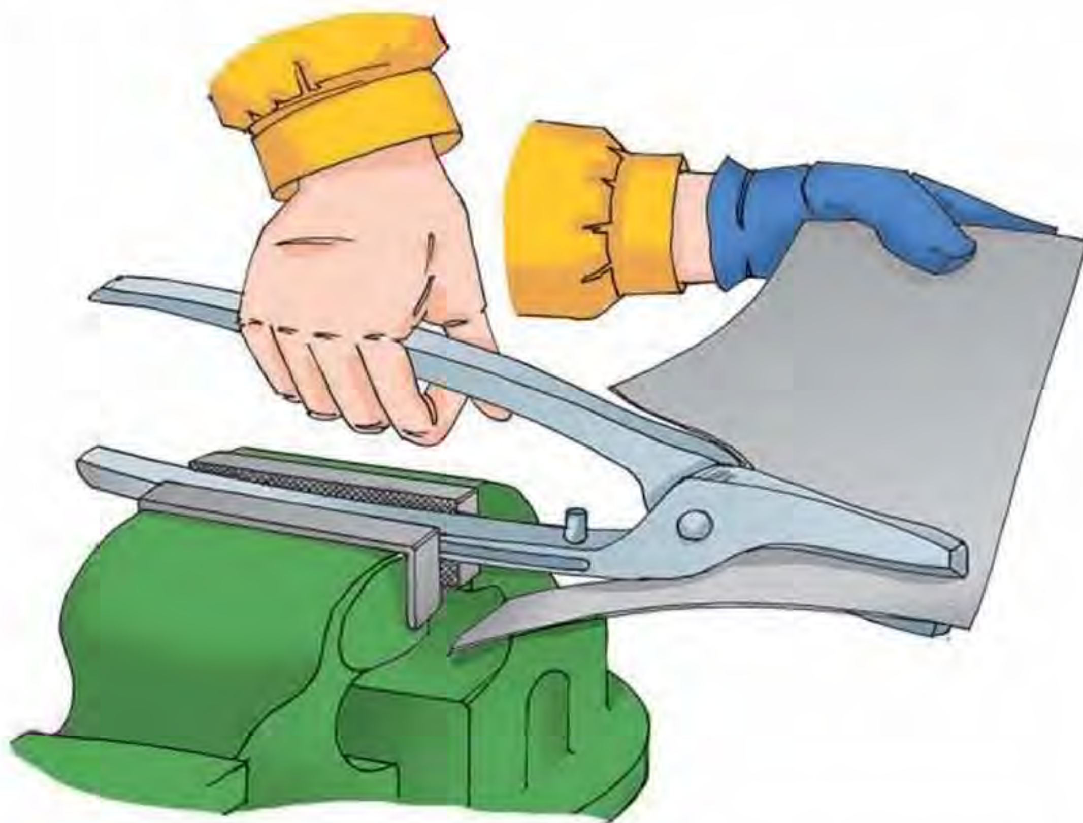
Мал. 75. Робота ножицями, закріпленими в лещатах
