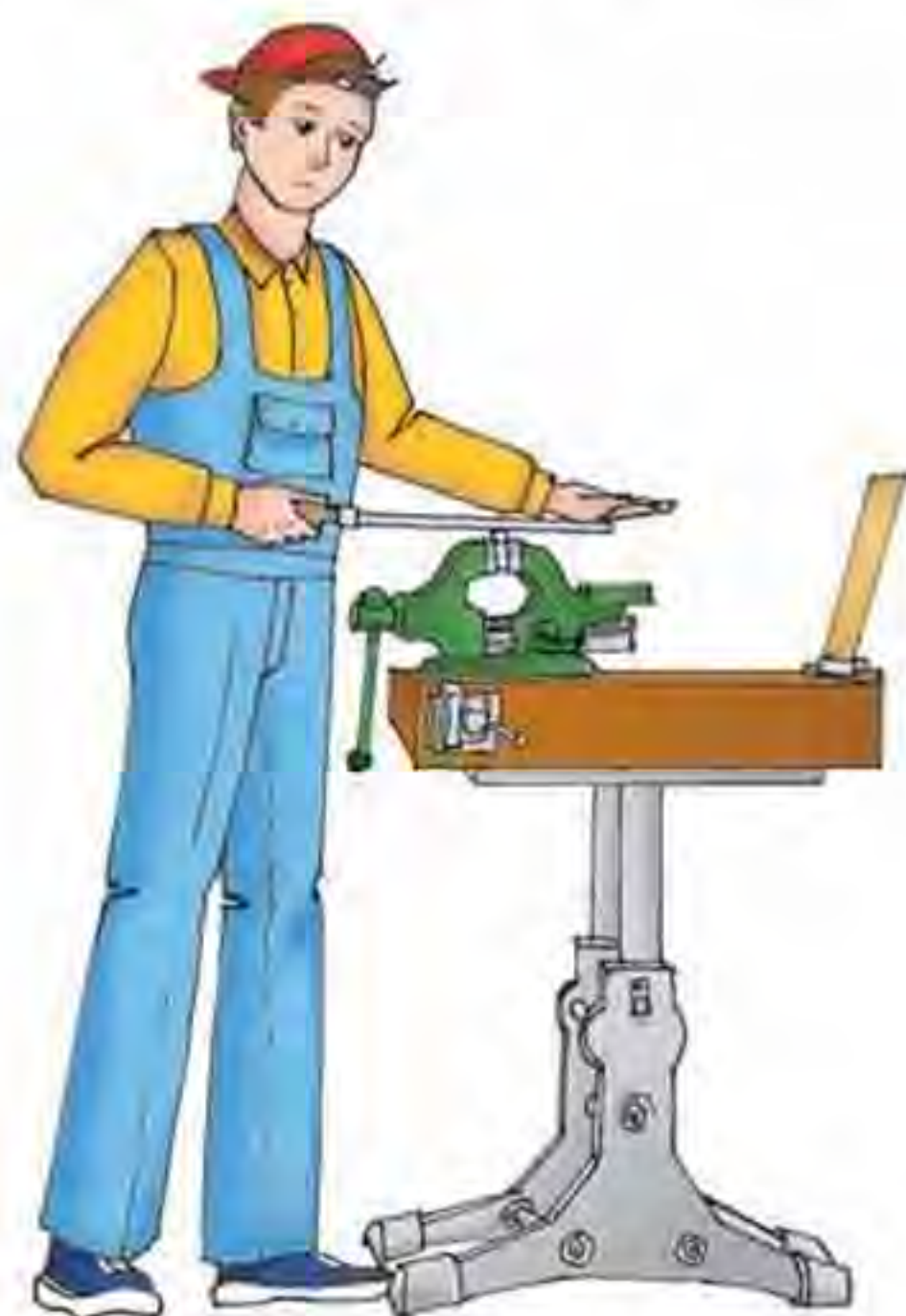
Мал. 83. Положення корпусу під час обпилювання деталі
