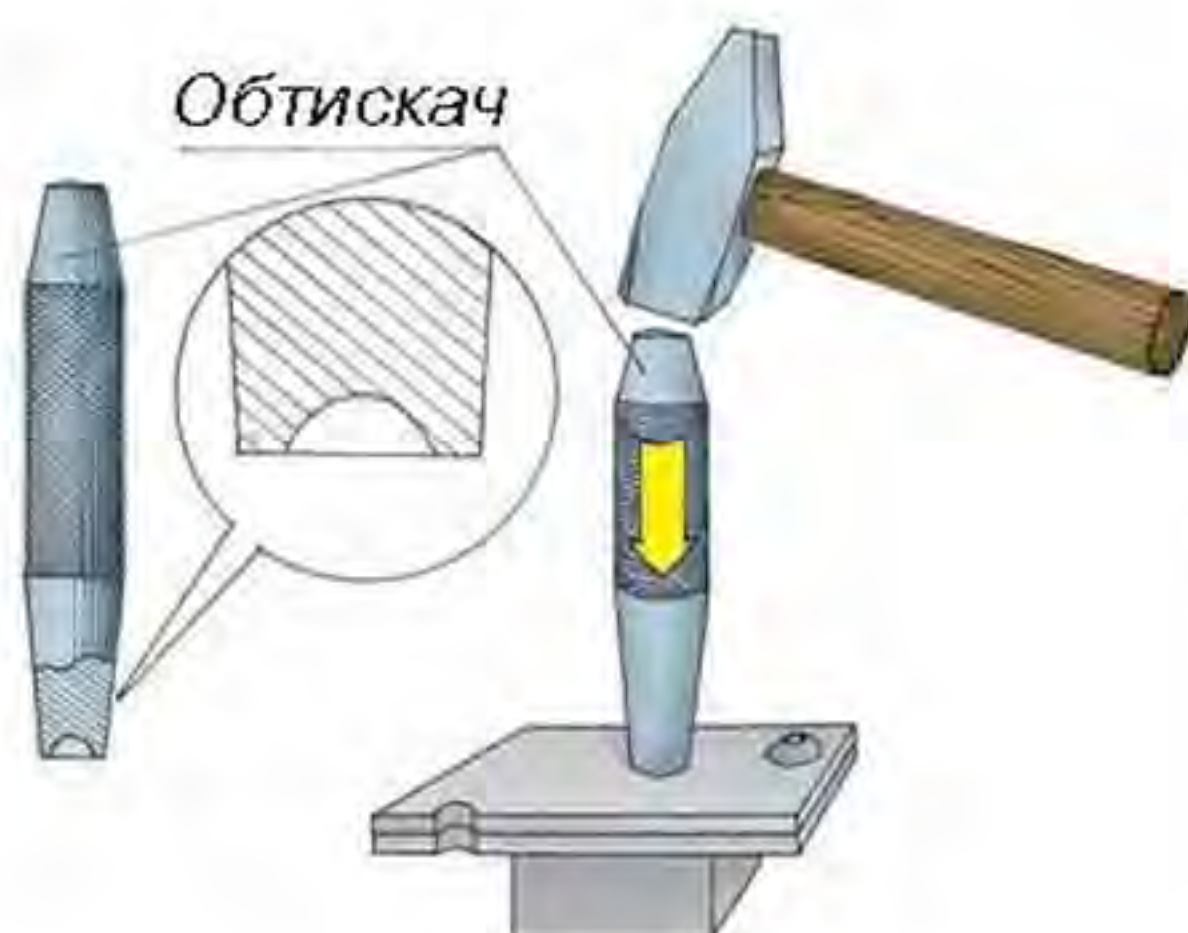
Мал. 117. Остаточне формування замикальної головки заклепки обтискачем
