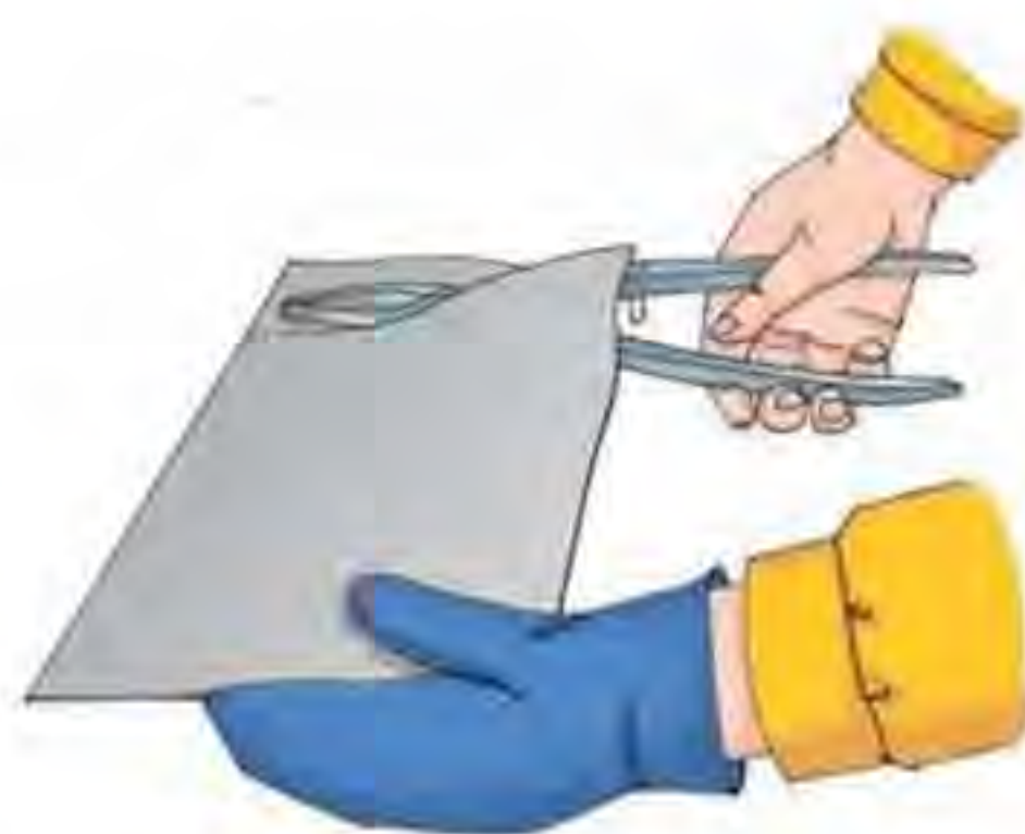
Мал. 74. Хватка ножиць при різанні тонколистового металу
