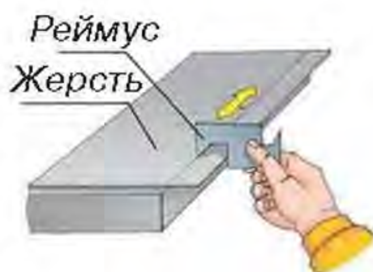
Мал. 118. Розмічання відгинів фальцювання рейсмусом
