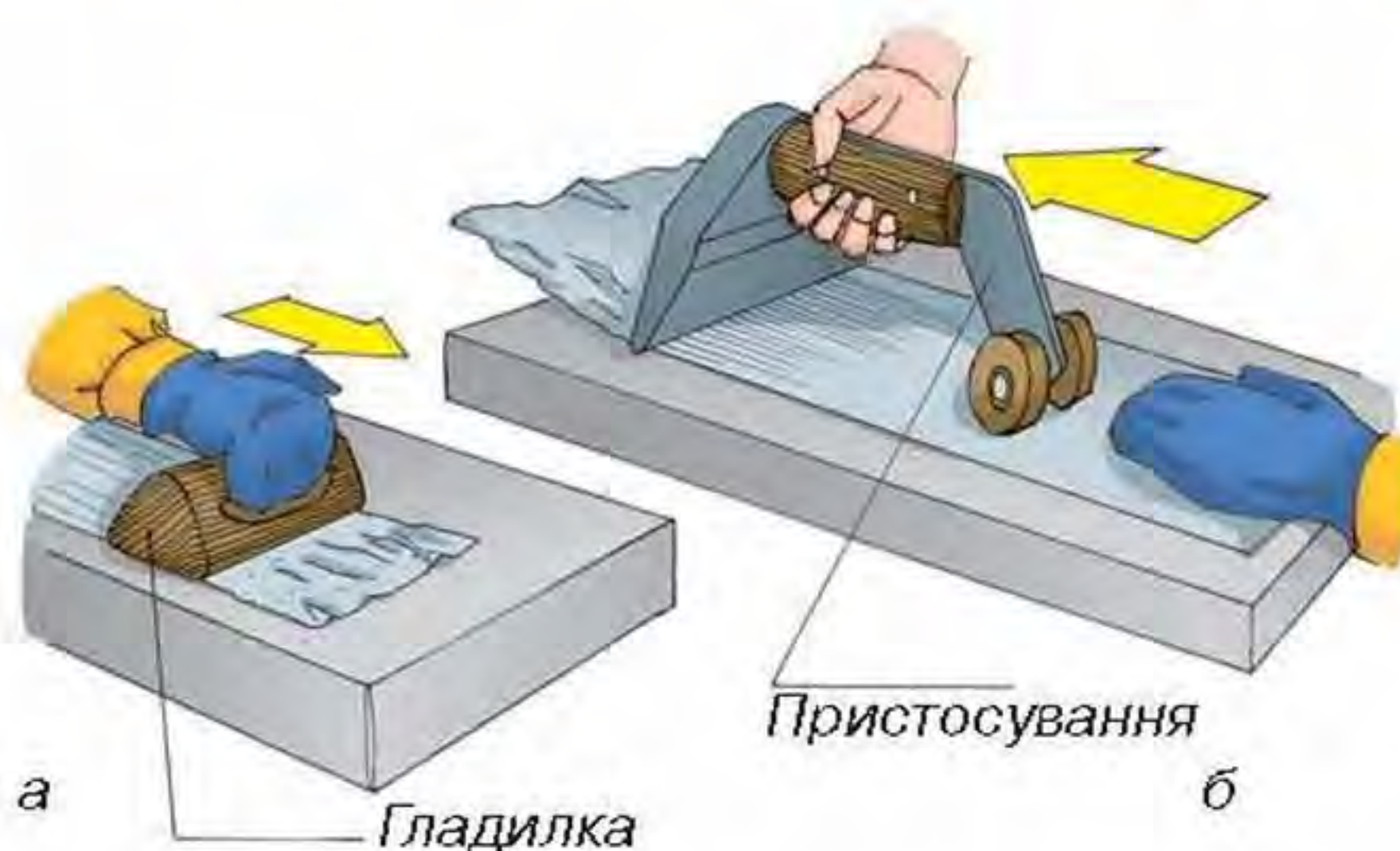
Мал. 59. Гладилки (а) та спеціальні пристосування для правлення фольги (б)
