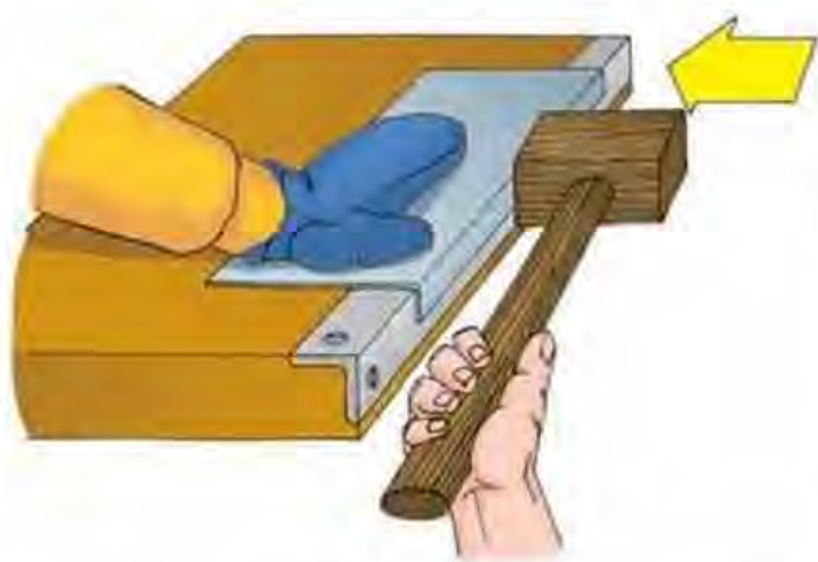
Мал. 108. Згинання країв заготовки для фальцювання
