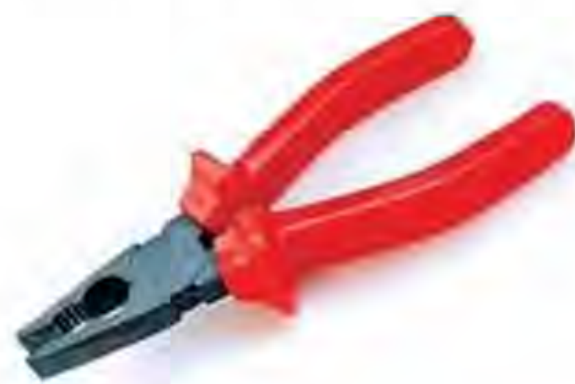
Мал. 128. Пасатижі — універсальний інструмент
