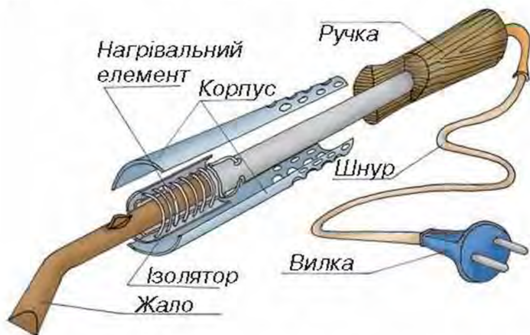
Мал. 104. Зовнішній вигляд та будова електропаяльника
