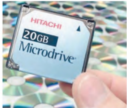
Рис. 3.15. Накопичувач на жорстких магнітних дисках
