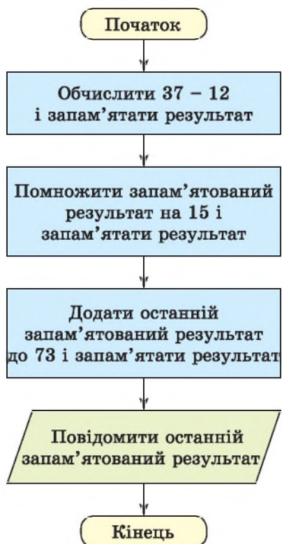
Рис. 1.20. Блок-схема алгоритму обчислення значення виразу 73 + (37 - 12) \cdot 15
