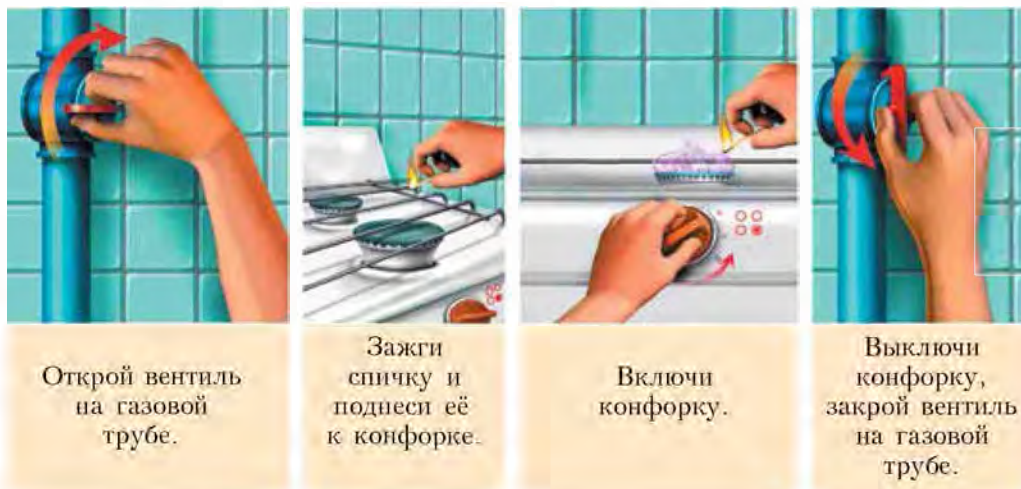
Рис. 52. Порядок включения и выключения газовой конфорки
