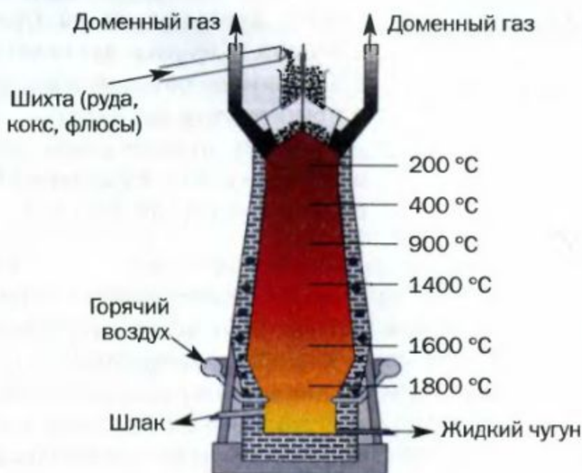
Рис. 111. Доменная печь в разрезе
