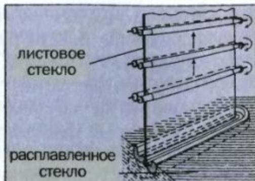
Рис. 66. Схема изготовления оконного стекла
