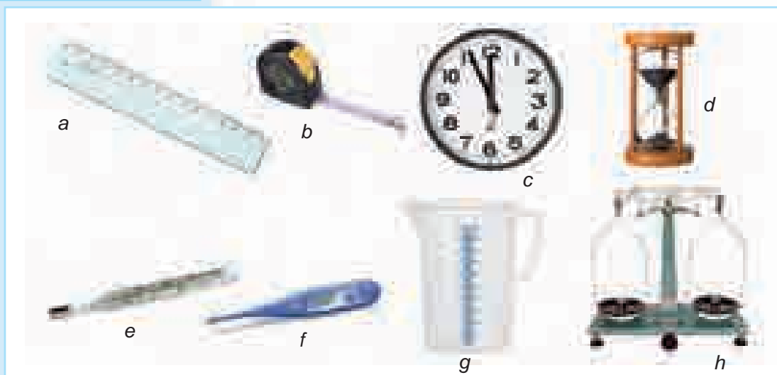
3. ábra. Mérőeszközök: a – vonalzó; b – mérőszalag; c – falióra; d – homokóra; e – higanyos lázmérő; f – digitális lázmérő; g – mérőpohár; h – mérleg
