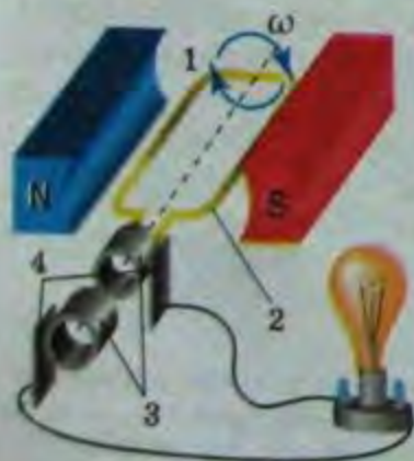
Мал. 169. Найпростіша модель індукційного генератора
