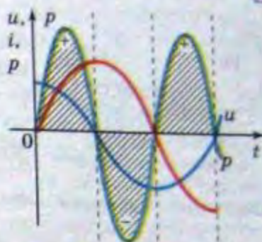
Мал. 156. Часові залежності напруги, сили струму і потужності в колі змінного струму з індуктивним опором
