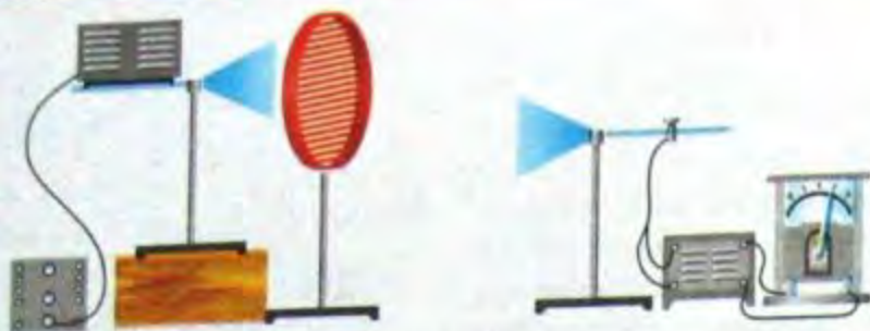
Мал. 195. Дослід з поляризації електромагнітних хвиль
