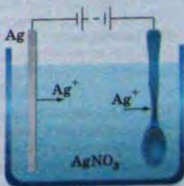
Мал. 88. Схема процесу гальваностегії
