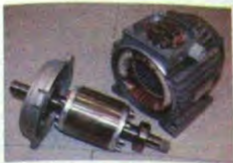
Мал. 170. Магнітна система генератора
