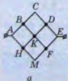
Мал. 46. Симетрична схема з'єднання провідників (а) та її еквівалентна схема (б)
