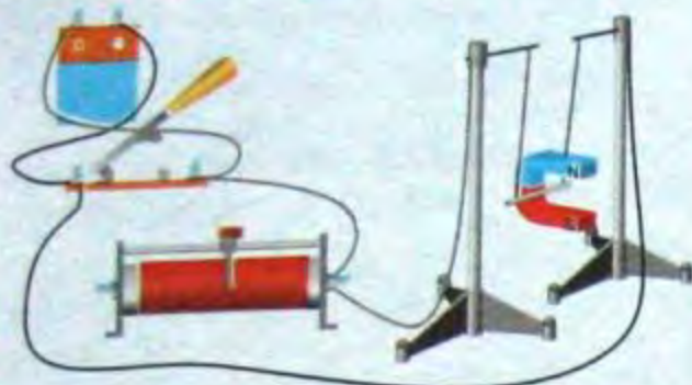
Мал. 118. Схема установки для дослідження дії магнітного поля на провідник зі струмом
