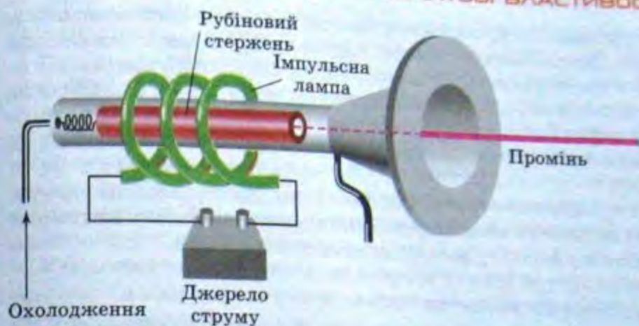
Мал. 290. Схема рубінового лазера
