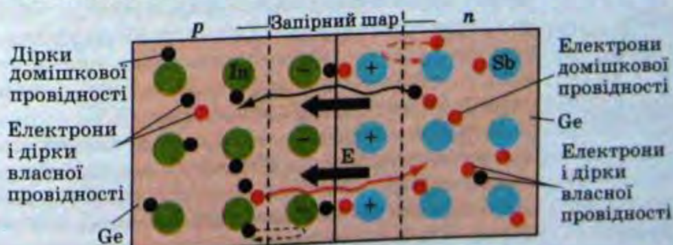
Мал. 76. Схема утворення p-n -переходу
