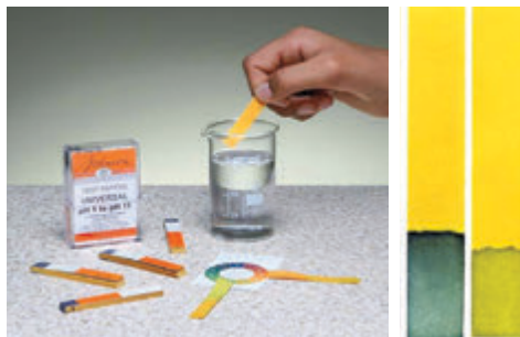
Рис. 33.4. Универсальный индикатор может не только обнаруживать кислоты или основания, но и определять их концентрации
