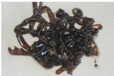
Рис. 23.2. а — кристаллическая сера; б — аморфная пластическая сера
