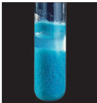
Рис. 38.1. О реакции купрум(II) хлорида и щелочи свидетельствует образование синего осадка купрум(II) гидроксида
