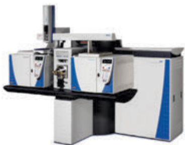
Рис. 43.3. Масс-спектрометр — прибор для определения относительных атомных и молекулярных масс
