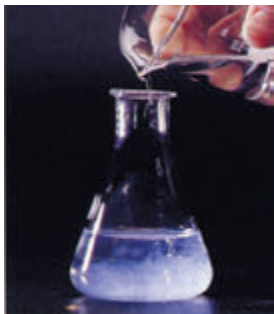
Рис. 38.3. Образование осадка малорастворимого кальций флуорида при сливании растворов натрия флуорида с кальций хлоридом
