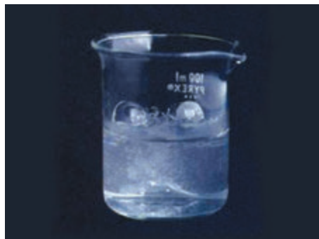
Рис. 36.6. При комнатной температуре магний взаимодействует с водой очень медленно, раствор слегка мутнеет вследствие образования малорастворимого магний гидроксида
