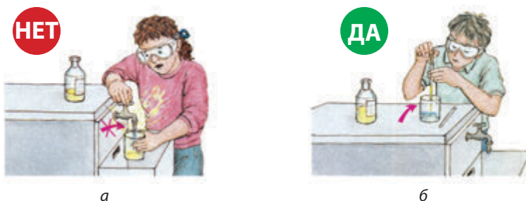
Рис. 35.2. Разбавление кислоты водой: а — неправильно, б — правильно
