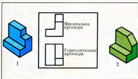
Мал. 9. Невизначеність форми предмета за двома проєкціями
