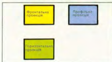
Мал. 13. Розміщення трьох проекцій деталі на площині
