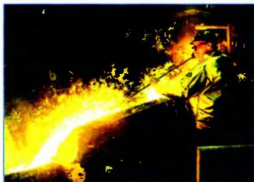
Мал. 135. Випуск розплавленої сталі з мартенівської печі
