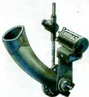
Рис. 13. Счетчик оборотов колеса велосипеда
