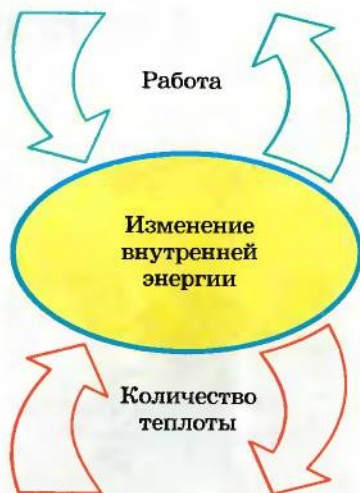
Рис. 138. Два способа изменения внутренней энергии тела
