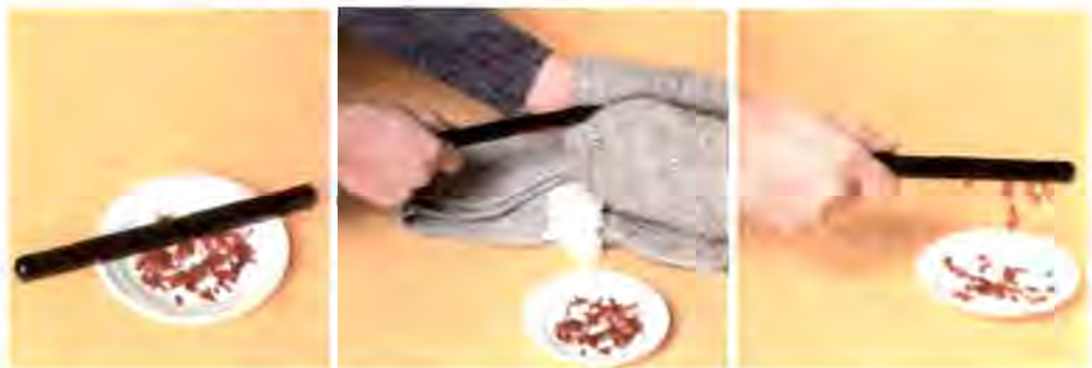
Мал. 47. Ебонітова паличка після натирання вовняною тканиною притягує клаптики паперу
