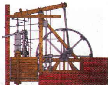
Парова машина Джеймса Ватта
