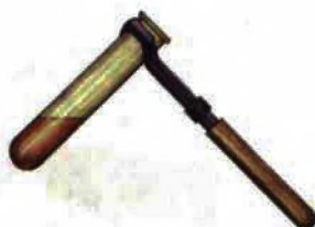
Мал. 12. Закріплення пробірки у тримачі
