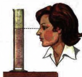
Мал. 15. Для правильного визначення об'єму позначка верхнього рівня рідини перебуває на одному рівні з очима
