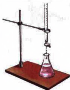
Мал. 20. Використання штативу для збирання нескладних приладів
