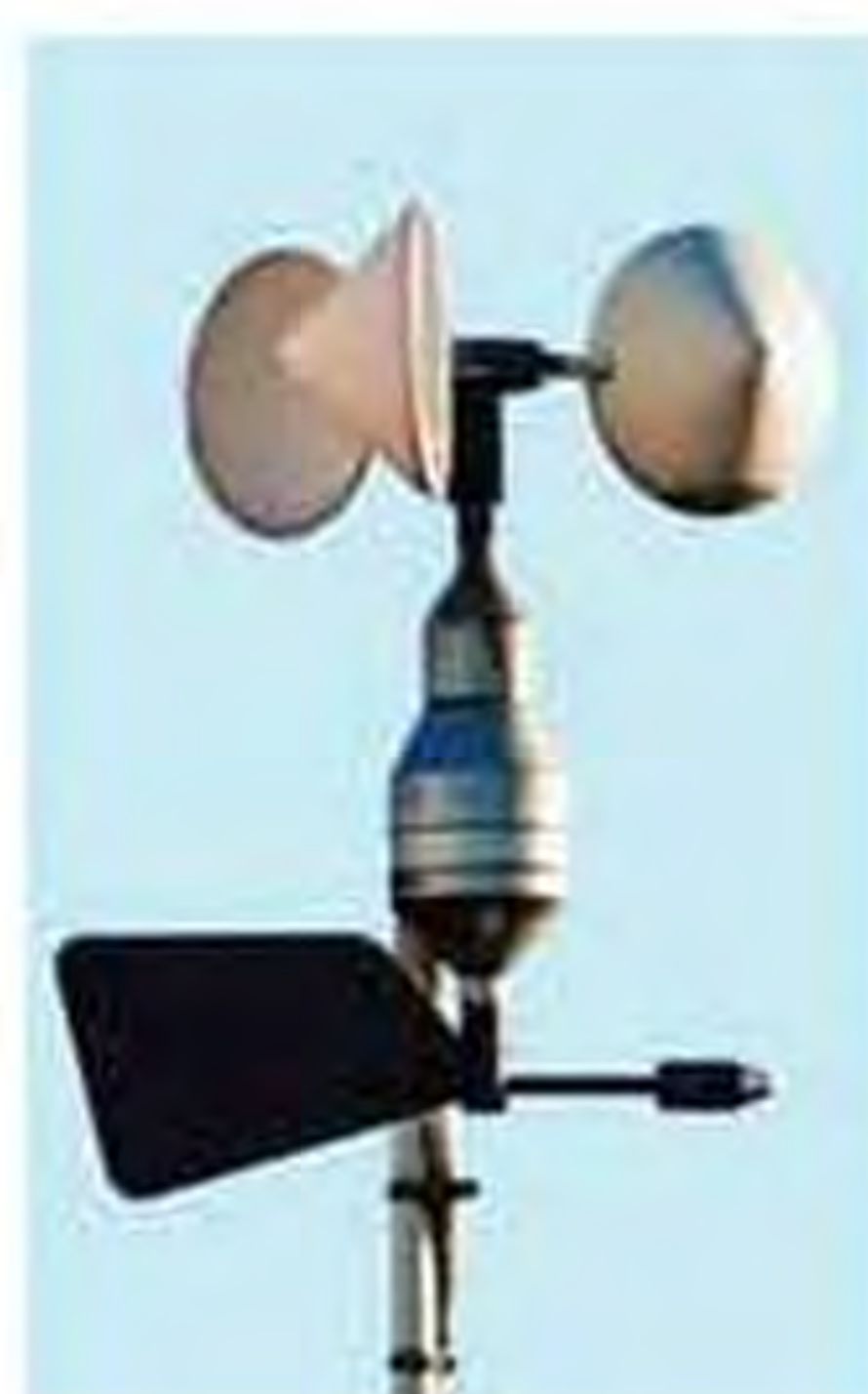
Мал. 143. Флюгер з анемометром
