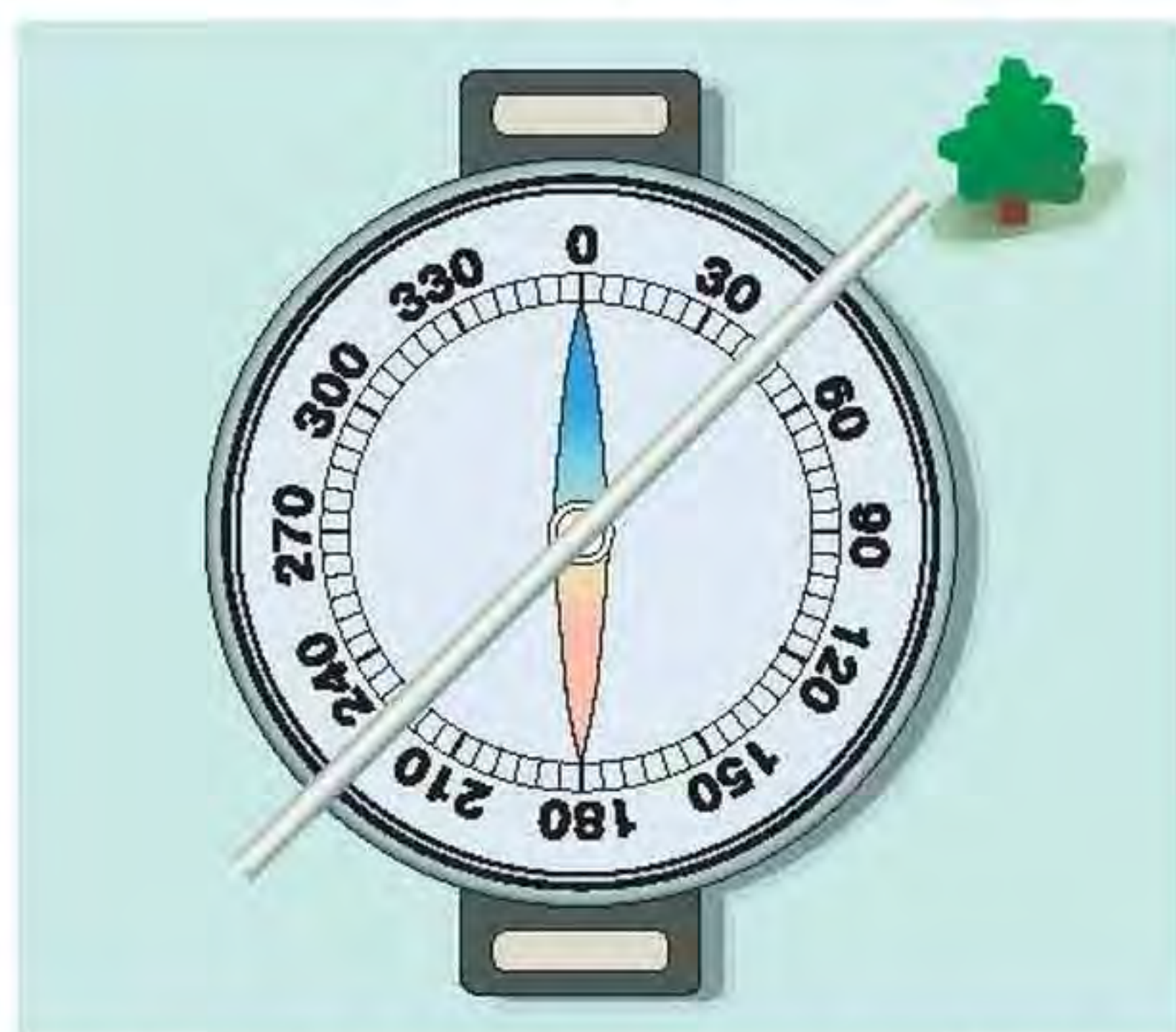
Мал. 30. Знаходження азимута за напрямком на предмет
