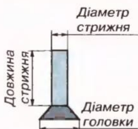
Мал. 94. Розміри елементів заклепки
