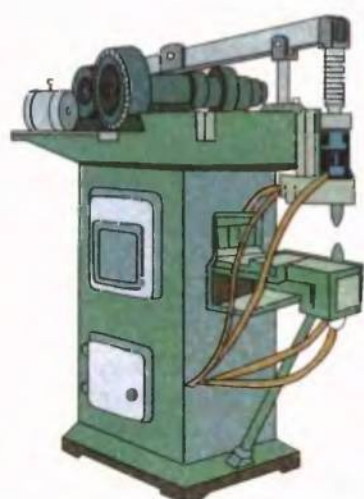
Мал. 91. Контактний електрозварювальний апарат: а – загальний вигляд; б – схема зварювання
