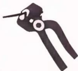
Мал. 86. Ручний кромкозгинальний інструмент
