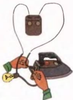
Мал. 136. Перевірка справ- ності нагрівального елемен- та електропраски
