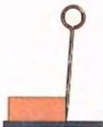
Мал. 55. Розміщення рисувалки під час розмічання
