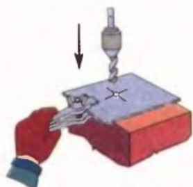
Мал. 99. Виконання отвору свердлом
