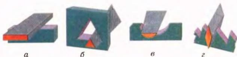
Мал. 73. Види обпилювання напилками: а – плоским; б – трикутним; в – півкруглим; з – ромбічним
