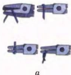
Мал. 110. Прийоми гнуття дроту: а – круглогубцями; б – на оправці
