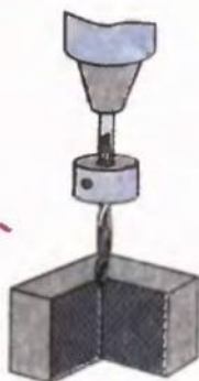
Мал. 41. Упор, закріплений на свердлі
