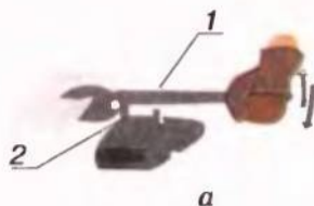
Мал. 63. Робота стільцевими ножицями: а – затиснутими в лещатах; б – закріпленими на дерев'яній основі
