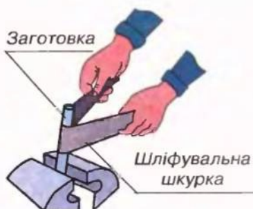
Мал. 119. Шліфування: a – плоских заготовок; б – циліндричних заготовок
