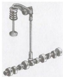
Розподільчий вал і схема його застосування для управління клапанами двигуна внутрішнього згоряння
