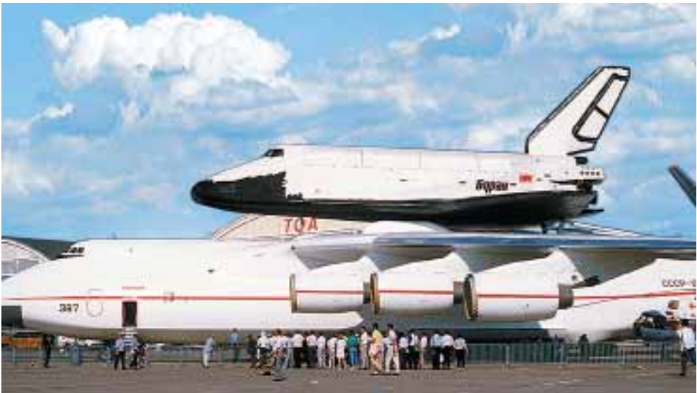
Samolot transportowy An-225 „Mrija” (Marzenie). Jest największym samolotem ciężarowym na świecie. Zaprojektowany i zbudowany w Kijowie w latach 1984–1988.
