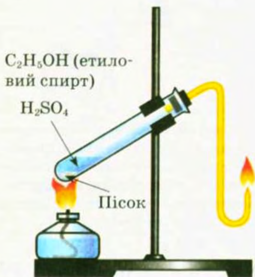
Мал. 88. Добування етилену в лабораторії
