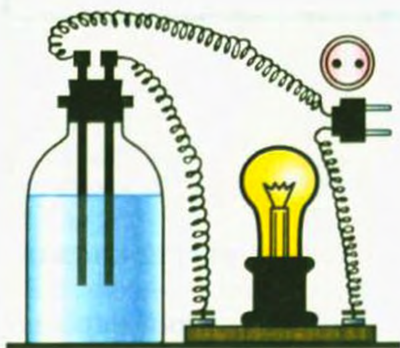
Мал. 38. Прилад для дослідження електричної провідності речовин та їх розчинів
