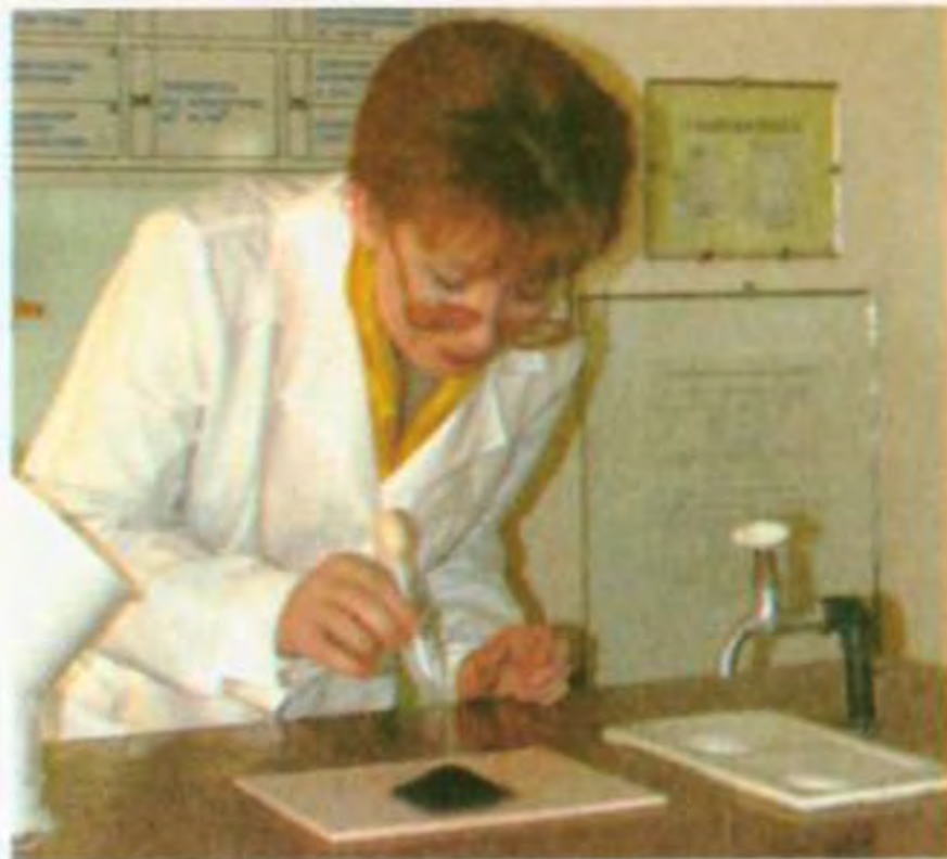
Мал. 60. Приготування суміші алюмінієвого пилю й порошку кристалічного йоду
