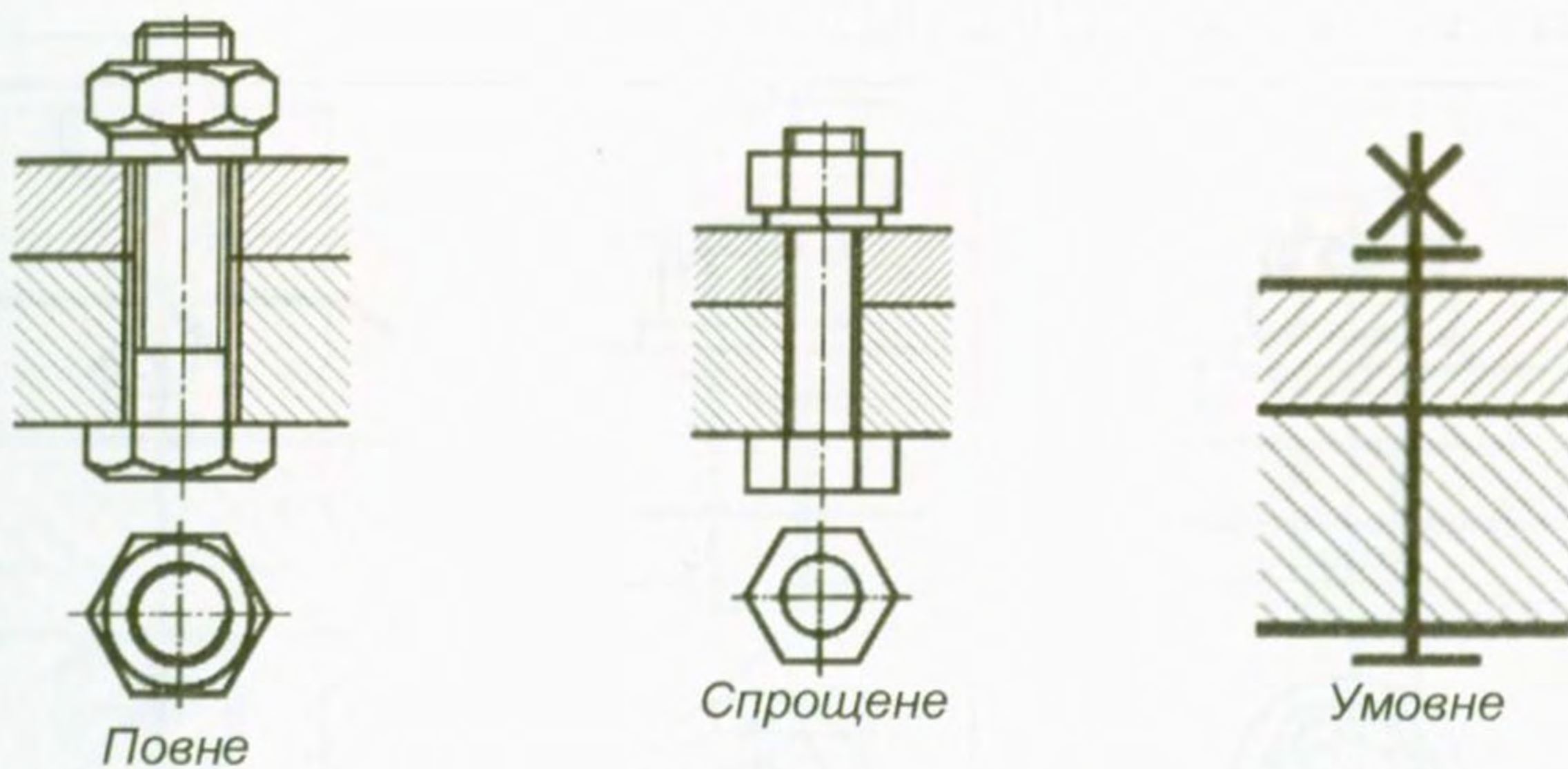
Рис. 89. Зображення болтового з'єднання
