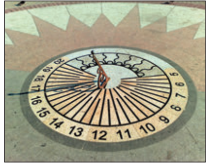
Рис. 1. Солнечные часы. Изменение длины тени гномона (это может быть вертикальная жердь или палка) указывает время суток днем.
