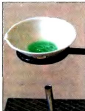
Мал. 16. Нагрівання рідини в порцеляновій чашці
