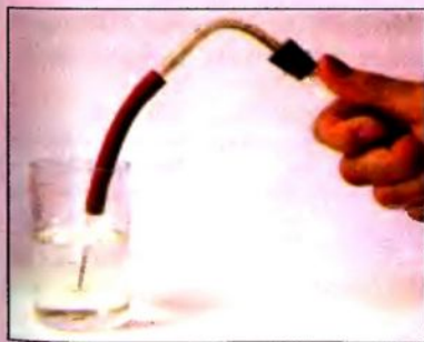
Мал. 60. Перевірка приладу на герметичність
