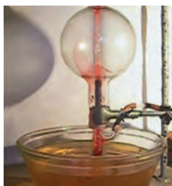
Рис. 5. Розчинення хлороводню у воді (дослід «Фонтан»)
