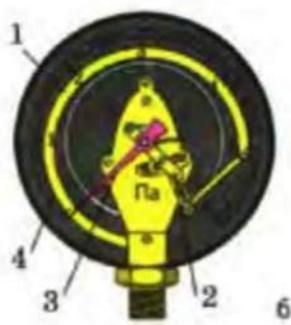
**Рис. 21.5.** Металлический деформационный манометр: *а* — общий вид; *б* — конструкция: трубка 1 с помощью передаточного механизма 2 прикреплена к стрелке 3. Давление определяют по шкале 4
