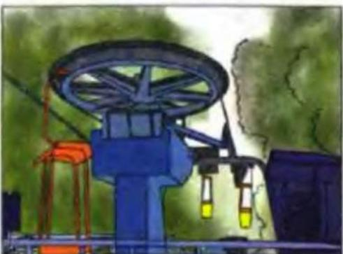
Рис. 16.3. Неподвижный блок в механизме канатной дороги меняет направление действия силы натяжения каната на противоположное
