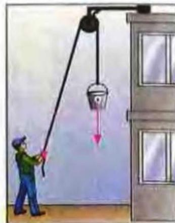
**Рис. 32.1.** Если в неподвижном блоке есть трение, то сила  $F$ , с которой человек должен тянуть веревку, больше веса груза
