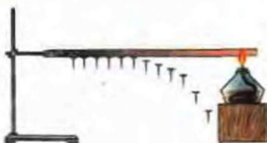
Рис. 36.1. Опыт, демонстрирующий теплопроводность металла
