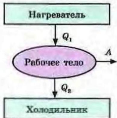
Рис. 42.2. Принцип работы тепловых машин: рабочее тело получает определенное количество теплоты ( $Q_1$ ) от нагревателя, эта теплота частично превращается в механическую энергию (рабочее тело выполняет работу  $A$ ), а частично ( $Q_2$ ) передается холодильнику
