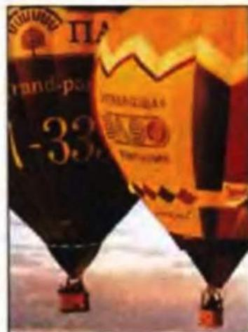
**Рис. 25.3.** Воздушные шары, поднимающиеся благодаря заполнению оболочки горячим воздухом, и сейчас называют монгольфьерами
