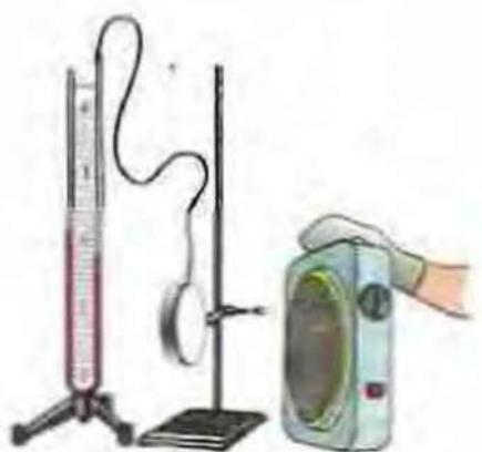
**Рис. 38.5.** Опыт, демонстрирующий, что способность тела поглощать тепло зависит от цвета его поверхности
