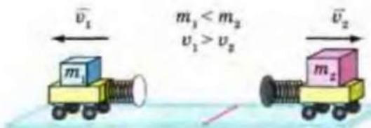
Рис. 10.4. Если тележки имеют разные массы, то под действием пружин они приобретут разные скорости и пройдут разные пути
