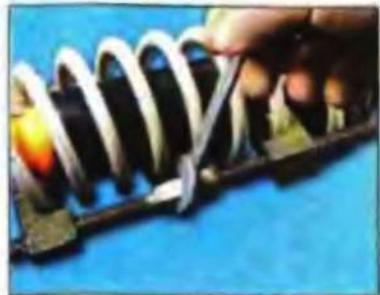
**Рис. 13.3.** Сжимая пружину, мы деформируем ее. При этом в пружине возникает сила упругости
