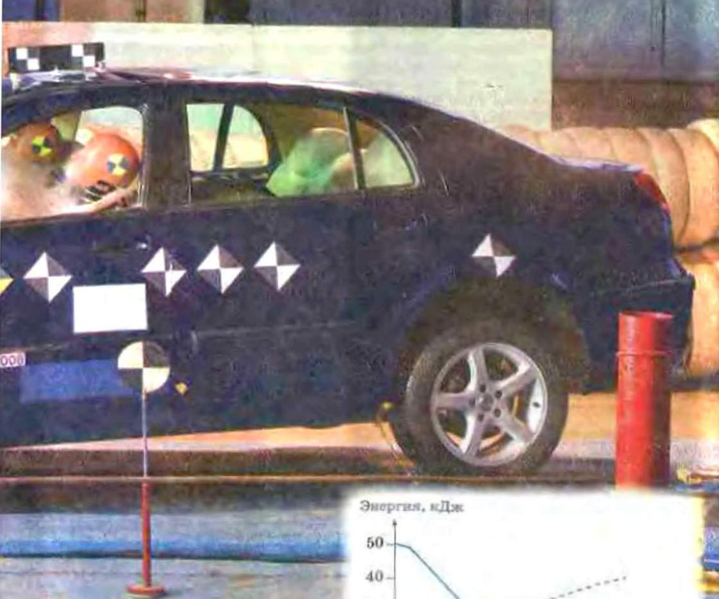
Результаты краш-теста: зависимость кинетической энергии (сплошная линия) и энергии деформации (пунктирная линия) от времени испытаний. Ноль на графике означает удар автомобиля о препятствие
