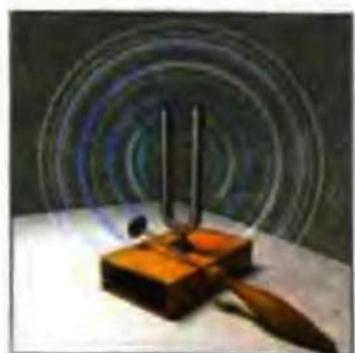
Рис. 8.3. Ножки камертона колеблются и издают звук
