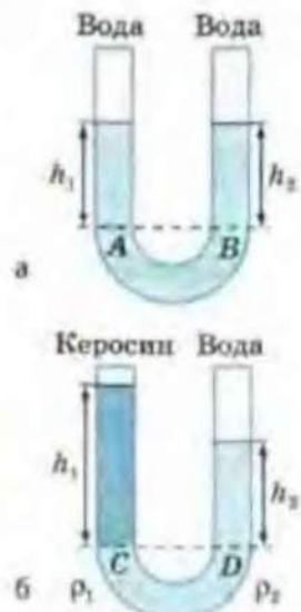
Рис. 21.2. В открытых сообщающихся сосудах однородная жидкость устанавливается на одном уровне (а); если жидкости имеют разные плотности, то столб жидкости с меньшей плотностью будет выше (б)
