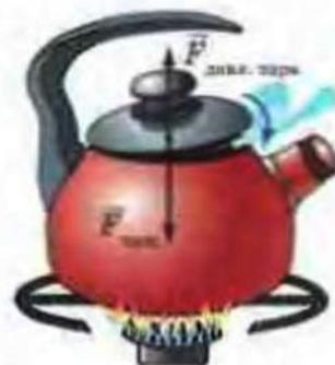
Рис. 42.1. На крышку чайника действуют сила тяжести ( $F_{\text{тяж.}} = mg$ ) и сила давления пара. Если  $F_{\text{дав. пара}} > F_{\text{тяж.}}$ , крышка подпрыгивает; если  $F_{\text{дав. пара}} < F_{\text{тяж.}}$ , крышка возвращается на место
