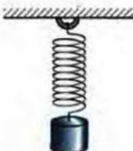
Рис. 6.4. Пример пружинного маятника: если тело, подвешенное на пружине, слегка толкнуть вниз, оно начнет колебаться
