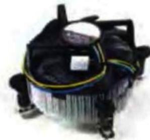
**Рис. 5.4.** Частота вращения лопастей вентиляторов в современных компьютерах составляет 50–60 оборотов в секунду
