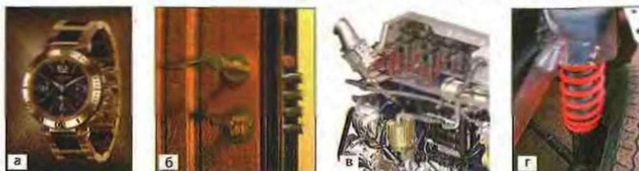
**Рис. 28.8.** Свойство деформированной пружины «запасать» потенциальную энергию, а потом за счет нее выполнять механическую работу используется во многих механизмах: механических часах (а); дверных замках (б); клапанах автомобильных двигателей (в); амортизаторах автомобилей (г) и т. д.
