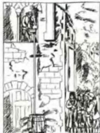
Рис. 19.4. Опыт, проведенный Б. Паскалем в 1648 г., продемонстрировал, что гидростатическое давление зависит от высоты столба жидкости
