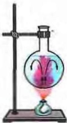
Рис. 37.1. Опыт, демонстрирующий конвекцию в жидкости. Окрашенные теплые струйки воды поднимаются, а холодные — опускаются
