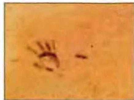
Рис. 17.1. Если на поверхность песка нажать рукой, то оставленный след, в частности его глубина, будет зависеть от того, как именно это было сделано — ладонью или пальцем (при одинаковой силе давления)
