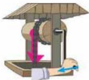
Рис. 4.14. Воду з колодязів зазвичай дістають за допомогою коловороту
