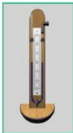
Рис. 3.71. Рідинний манометр
