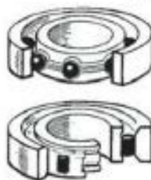
Рис. 3.43. Будова підшипників
