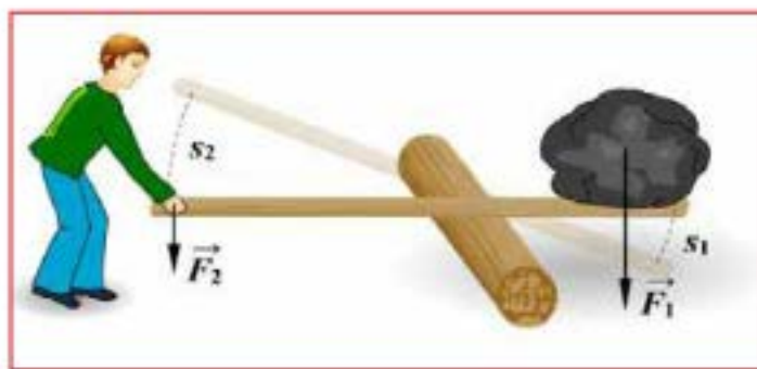
Рис. 4.34. Сили, прикладені до плечей важеля виконують роботу
