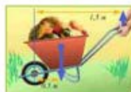
Рис. 4.22. У важелі третього типу обидві точки прикладення сил лежать по один бік від точки опори і тягар має більше плече
