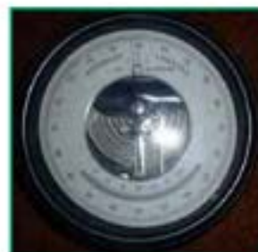
Рис. 3.66. Барометр-анероїд
