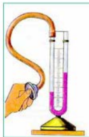
Рис. 3.72. Дія рідинного манометра
