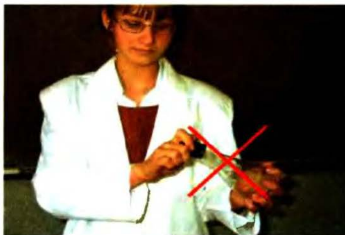
Мал. 33. Закривання колби пробкою: а — правильне; б — неправильне
