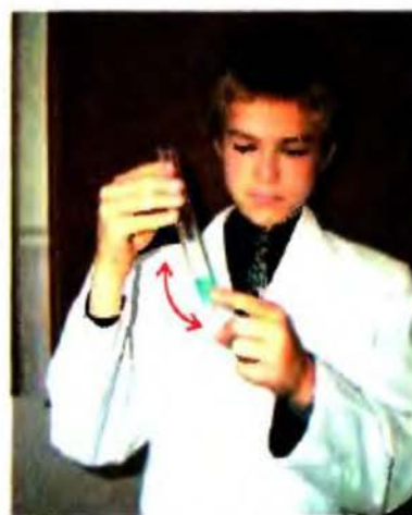
Мал. 28. Так треба струшувати рідину в пробірці
