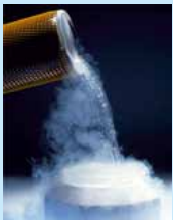
Мал. 3.4. Рідкий азот кипить при -196^{\circ}\text{C}
