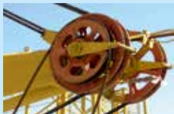
Мал. 34.2. Блок змінює напрямок дії сили
