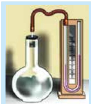
Мал. 27.2. Відкритий рідинний манометр
