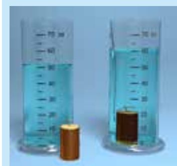
Мал. 6.8. Поділкі мензурки визначають об'єм у мілілітрах (тобто \text{см}^3 )
