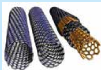
Мал. 37.3. Вуглецеві нанотрубки набагато легші та міцніші за сталь
