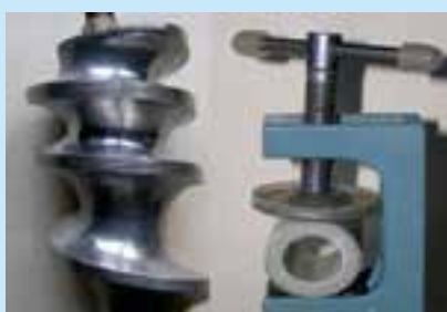
Мал. 34.9. Шнек м'ясорубки і гвинт струбцини – різновиди похилої площини
