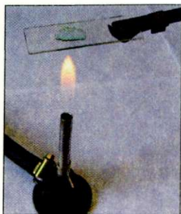
Рис. 17. Выпаривание жидкости на предметном стекле
