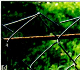
Рис. 69. Коррозия железа: а — бочка, которую «съела» ржавчина; б — ржавая проволока, на которой закреп- лена оцинкованная железная сетка
