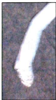
Рис. 65. Сильно нагретая алюминиевая проволока
