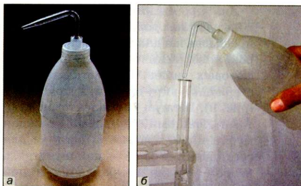
Рис. 7. Промывалка (а) и ее использование (б)
