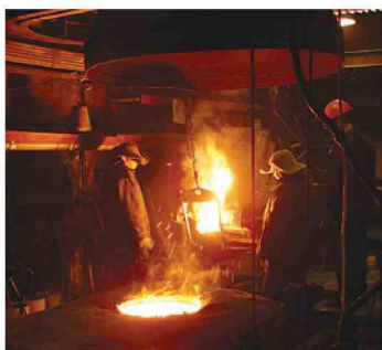
Мал. 123. Виготовлення деталей литтям
