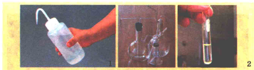
Мал. 2.4. 1. Промивалки використовують для промивання осадів, ополіскування посуду, наливання рідин малими дозами до певного об'єму. 2. Перемішування рідини й твердої речовини у пробірці
