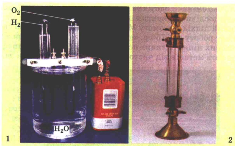
Мал. 15.4. 1. Прилад для розкладання води електричним струмом. 2. Евдіометр (у буквальному перекладі з грецької – «вимірник добротності») – прилад для аналізу повітря
