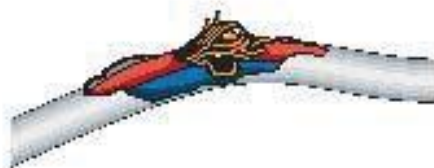
Мал. 116. Пошкодження ізоляції у шнурах живлення
