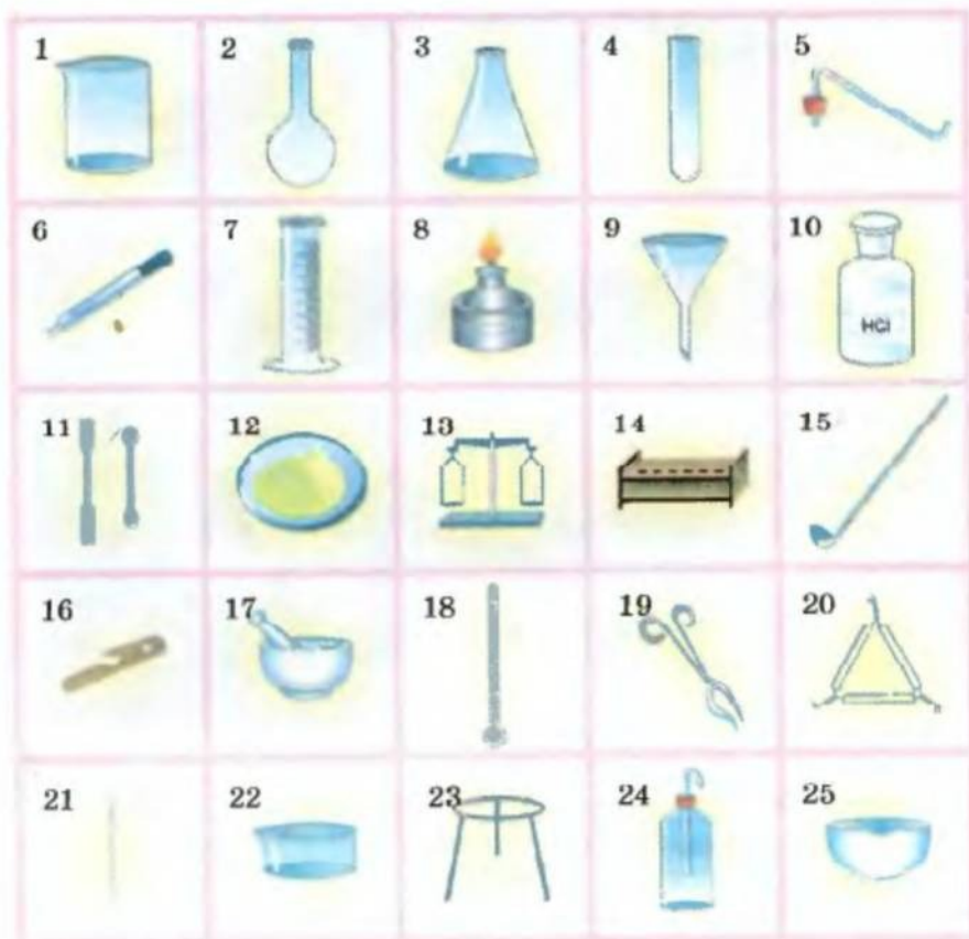
Рис. 2.10. 1 – химический стакан, 2 – круглодонная колба, 3 – коническая колба, 4 – пробирка, 5 – пробка с газоотводной трубкой, 6 – пипетка, 7 – мерный цилиндр, 8 – спиртовая горелка, 9 – воронка, 10 – стеклянная банка для хранения реактивов, 11 – шпатели, 12 – стеклышко, 13 – весы, 14 – штатив для пробирок, 15 – лопатка для сжигания веществ, 16 – держатель для пробирок, 17 – ступка с пестиком, 18 – термометр, 19 – тигельные щипцы, 20 – фарфоровый треугольник, 21 – стеклянная палочка, 22 – кристаллизатор, 23 – треножник, 24 – промывалка, 25 – фарфоровая чашка
