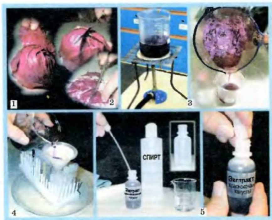
Рис. 2.6. 1. Краснокочанная капуста. 2. Измельчение. 3. Изготовление отвара. 4. Фильтрация отвара. 5. Добавление пипеткой спирта
