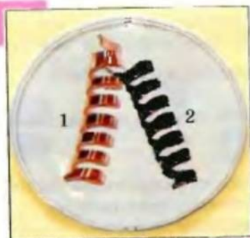
Рис. 3. Медная спираль до (1) и после (2) прокаливания
