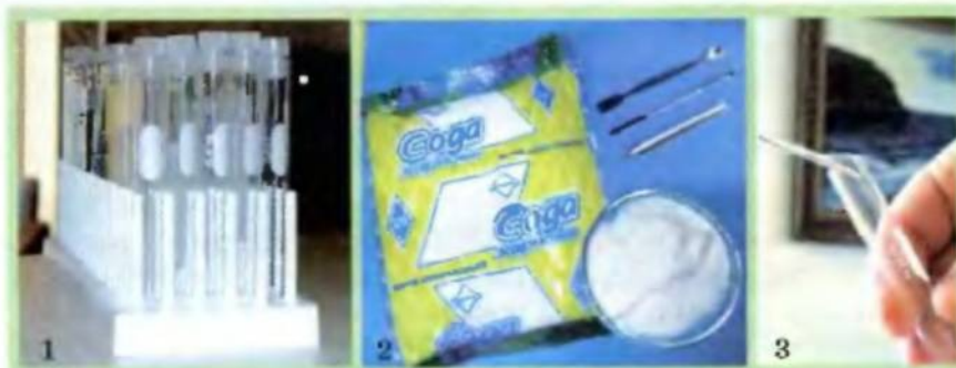
Рис. 2.3. 1. Штатив с пробирками. 2. Питьевая (пищевая) сода, шпатели. 3. Отбор питьевой соды в пробирку шпателем
