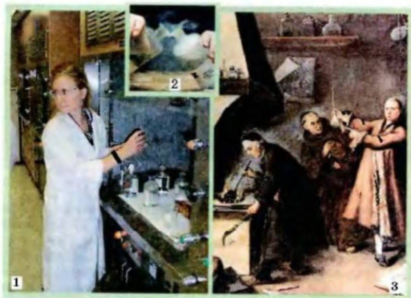
Рис. 3.2. В современной лаборатории (1) опыты с летучими веществами (2) проводят под тягой. Алхимики (3) поступали так же
