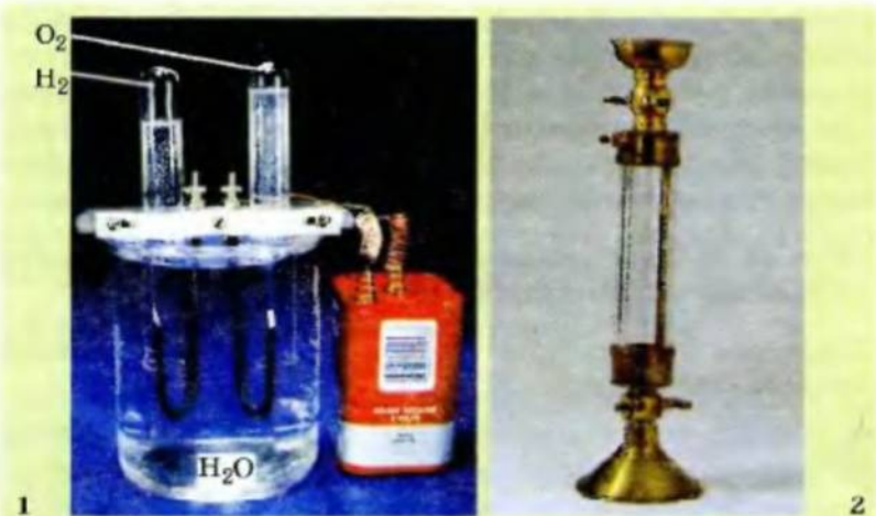
Рис. 15.4. 1. Прибор для разложения воды электрическим током. 2. Эвдиометр (в буквальном переводе с греческого – «измеритель добротности») – прибор для анализа воздуха
