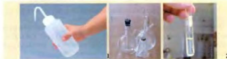
Рис. 2.4. 1. Промывалки используют для промывания осадков, ополаскивания посуды, доливания жидкостей малыми дозами до определенного объема. 2. Перемешивание жидкости и твердого вещества в пробирке
