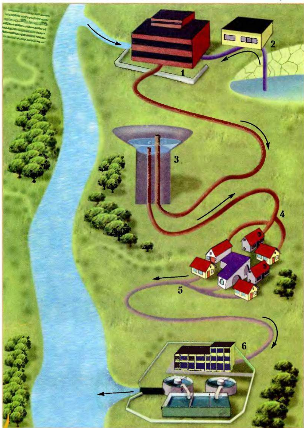
Рис. 25.6. Схема системы водоснабжения и очистки воды. В нашей стране значительная часть потребляемой воды поступает из рек, остальная — из подземных источников
