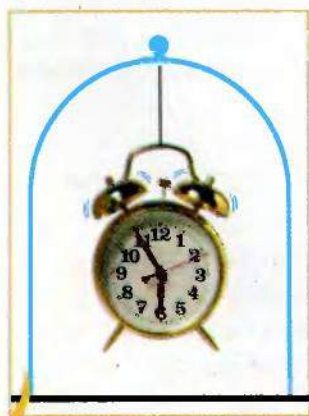
Рис. 16.1. Из емкости откачан воздух — звонок будильника не слышен
