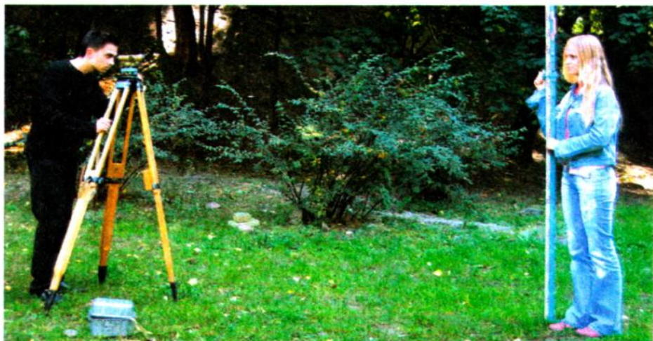
Рис. 46. Нивелирование на местности
