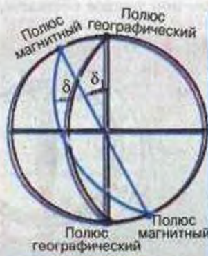
Рис. 25. Соотношение между магнитным и истинным азимутами и дирекционным углом
