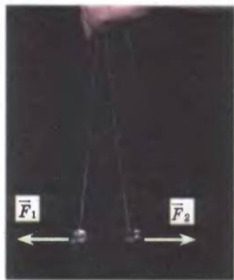
Рис. 19.4. На кожен з двох однако- йменно заряджених кульок діє сила Кулона з боку іншої кульки. Ці сили є рівними за модулем і протилежними за напрямком: \vec{F}_1 = -\vec{F}_2
