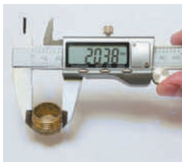
2.3. ábra. Tolómérce. Mérési pontossága a milliméter századrésze
