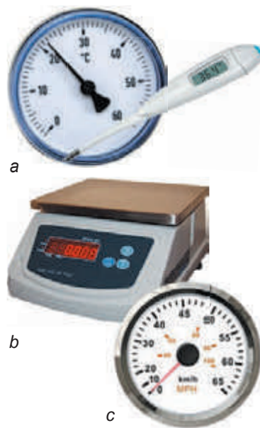
2.2. ábra. Hőmérséklet (a), tömeg (b) és sebesség (c) közvetlen mérésre szolgáló modern eszközök
