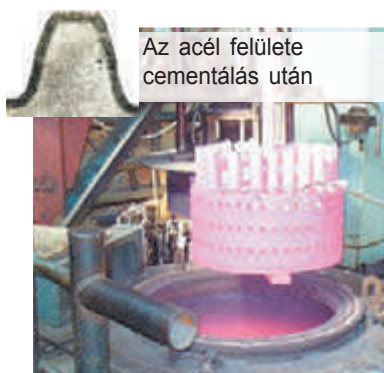
27.4. ábra. Az acél felületének szénnel történő dúsítását cementálásnak nevezik. Ha a terméket alacsony széntartalmú acélból készítik, majd magas hőmérsékletű, szént tartalmazó elegybe merítik, akkor a diffúzió hatására a felső réteg szénnel telítődik. A kapott elem egyidejűleg nagyon szilárd lesz (kívülről – szilárd öntöttvas) és nem rongálódik az ütés általi terhelések folyamán (belülről – rugalmas acél)
