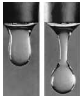
33.5. ábra. A keskeny rés mellett addig marad meg a csepp, amíg a felületi feszültségi erő kiegyenlíti a nehézségi erőt
