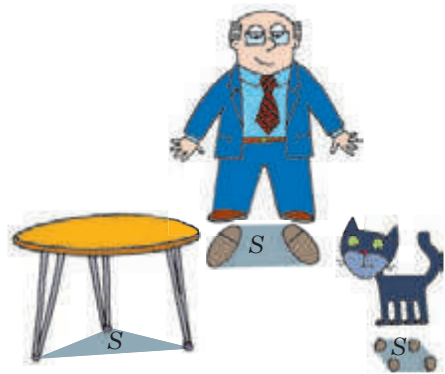
14.3. ábra. Egyes testek támasztási felületei (jelölése S)
