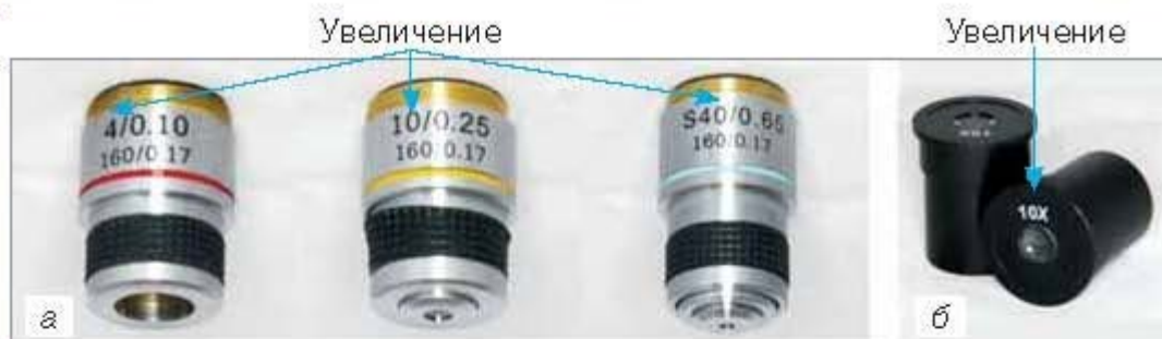
Рис. 7. Объективы (а), окуляр (б) и их маркировка
