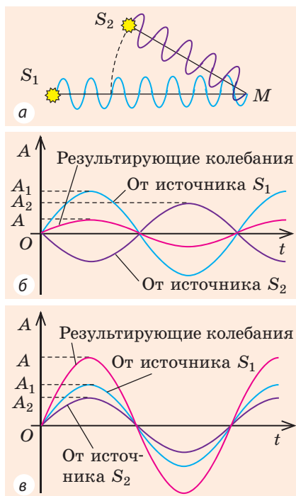
Рис. 22.6. Волны от двух источников ( S_1 , S_2 ) приходят в точку M и накладываются друг на друга (а). Если волны поступили в противоположных фазах, амплитуда результирующих колебаний уменьшается: A = A_1 - A_2 (б), а если в одинаковых фазах, амплитуда результирующих колебаний увеличивается: A = A_1 + A_2 (в)
