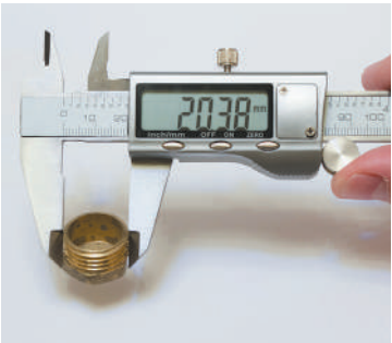
Рис. 2.3. Штангенциркуль. Точность измерения изображенным прибором — сотые доли миллиметра
