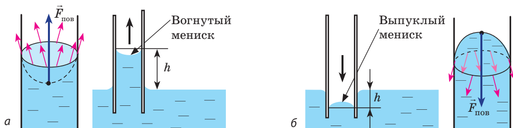
Рис. 33.8. Капиллярные явления: а — смачивающая жидкость поднимается по капилляру; б — несмачивающая жидкость опускается в капилляре
