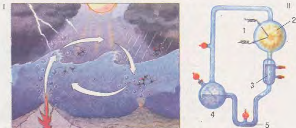
Мал. 41.2. I. Гіпотетичні умови для створення життя на Землі. II. Дослід Опаріна–Холдейна: 1 – електроди; 2 – суміш газів ( \text{CH}_4 , \text{NH}_3 , \text{H}_2 , \text{H}_2\text{O} ); 3 – конденсор; 4 – підігрів води; 5 – дрібні органічні молекули
