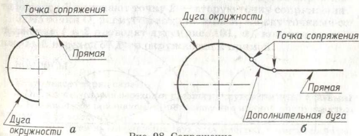
Рис. 98. Сопряжение дуги окружности и прямой
