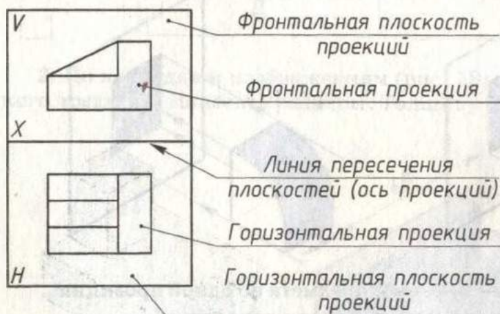
Рис. 62. Взаимное размещение фронтальной и горизонтальной проекций
