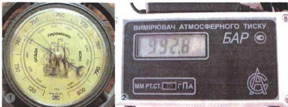
Мал. 94. Барометр-анероїд (1), електронний барометр (2)
