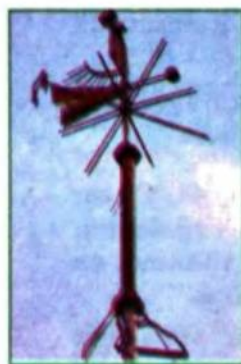
Рис. 18.4. Флюгер, за допомогою якого визначають напрямок і швидкість вітру
