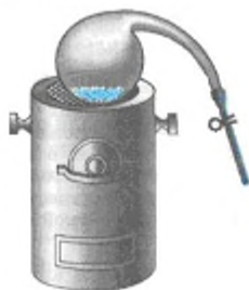
Мал. 51. Прожарювання металу в запаяній реторті
