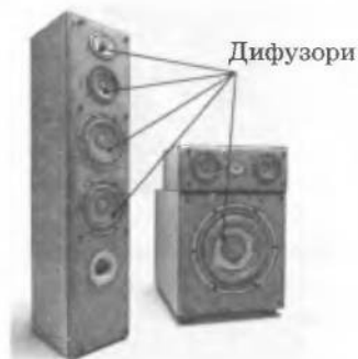
Рис. 8.2. У гучномовцях звук спричиняється коливанням дифузорів
