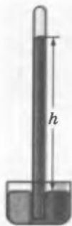
Рис. 20.3. Моделювання досліду Е. Торрічеллі: висота h ртуті в трубці завжди становить близько 760 мм
