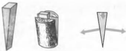
Рис. 31.6. Клин не тільки дає вигреш у силі, але й змінює її напрямок
