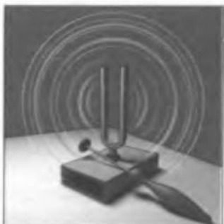
Рис. 8.3. Ніжки камертона коливаються й тому випромінюють звук
