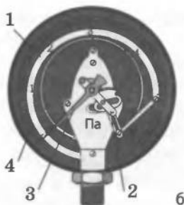
Рис. 21.5. Металевий деформаційний манометр: a — загальний вигляд; b — конструкція: трубку 1 за допомогою передавального механізму 2 прикріплено до стрілки 3. Тиск визначають за шкалою 4
