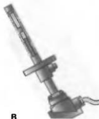
Рис. 33.3. Різні види термометрів: а — рідинний (мірою температури є довжина стовпчика рідини); б — металевий (біметалічна пластинка, яка з'єднана зі стрілкою термометра, вигинається в результаті нагрівання); в — термометр опору (зі зміною температури змінюється сила електричного струму в колі); г — медичний (унаслідок зміни температури змінюється колір відповідної ділянки термометра)
