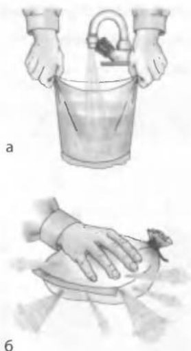
Рис. 18.6. Натиснемо на пакет із водою — він, найімовірніше, прорветься не в місці, де ми на нього натиснули, а в іншому: вода передасть додатковий тиск в усі боки
