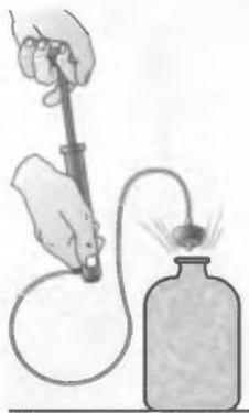
Рис. 35.6. Дослід, який підтверджує, що в ході виконання повітрям роботи його внутрішня енергія зменшується. Доказом цього є поява туману в посудині
