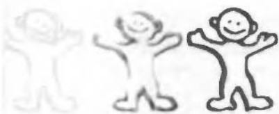
Рис. 46.3. Демонстрація залежності швидкості випаровування від роду рідини. Через хвилину фігурка, яку намальовано спиртом, повністю зникла (а); фігурка, намальована водою, залишилася частково (б); випаровування олії зовсім не помітне (в)
