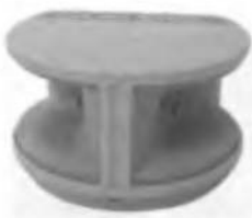
Рис. 8.5. Ультразвуковий випромінювач, що відганає комах
