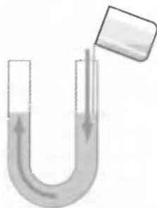
Рис. 21.1. У разі наливання рідини в одне коліно U-подібної трубки вона перетікає в друге коліно
