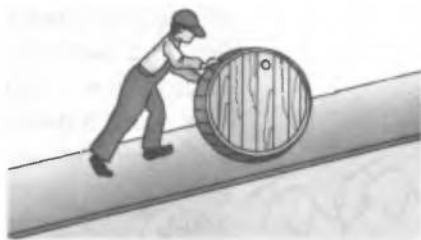
Рис. 31.4. Похила площина є незамінною, коли потрібно підняти вантаж. Чим пологіший ухил площини, тим легше виконати цю роботу
