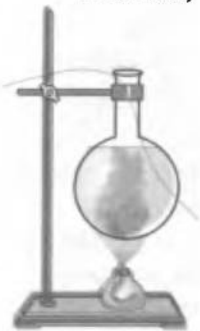
Рис. 37.1. Дослід, що демонструє конвекцію в рідині. Теплі забарвлені струминки води піднімаються, а холодні — опускаються
