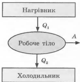
Рис. 42.2. Принцип дії теплових машин: робоче тіло одержує певну кількість теплоти ( Q_1 ) від нагрівника, ця теплота частково перетворюється на механічну енергію (робоче тіло виконує роботу A ), а частково ( Q_2 ) передається холодильнику
