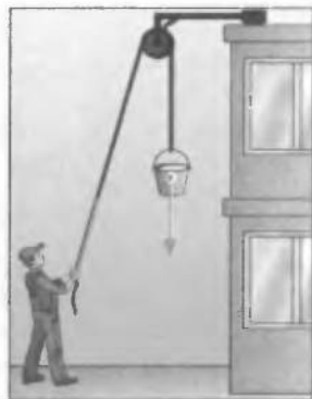
Рис. 32.1. Якщо в нерухомому блоці є тертя, то сила F , з якою людина має тягти мотузку, більша за вагу вантажу
