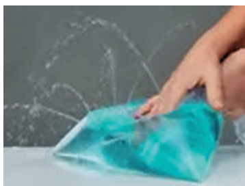
Рис. 23.5. Вода передает оказываемое на нее давление во всех направлениях и в результате выливается из отверстий в пакете во все стороны
