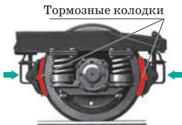
Рис. 33.4. Колесо поезда во время торможения
