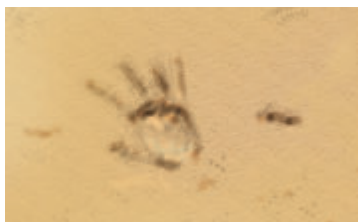
Рис. 22.2. Если на поверхность песка нажать рукой, то глубина следа будет зависеть от того, как именно это было сделано — ладонью или пальцем (при одинаковой силе давления)
