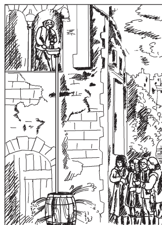
Рис. 24.3. В 1648 г. Блез Паскаль, добавив в трубку всего один стакан воды, «разорвал» бочку
