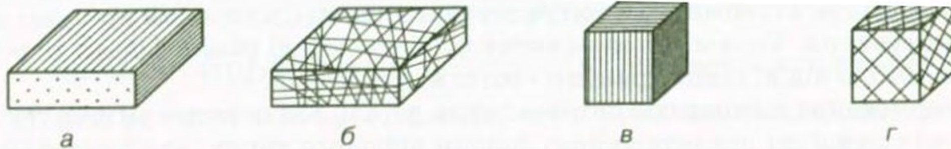
Мал. 28. Схема розміщення волокон в армованих деталях
