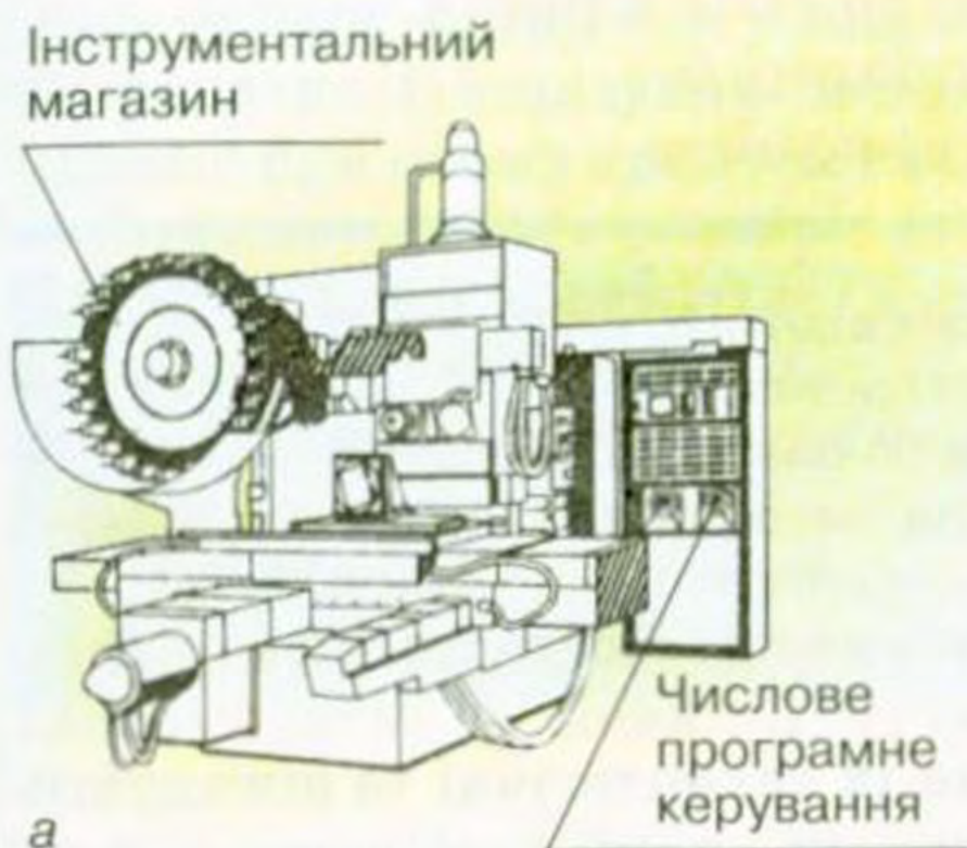
Мал. 32. Верстати з ЧПК: а – горизонтальний свердлильно-фрезерно-розточувальний з інструментальним магазином (оброблювальним центром); б – багатофункціональний верстат з автоматичною зміною інструмента і оброблюваних деталей
