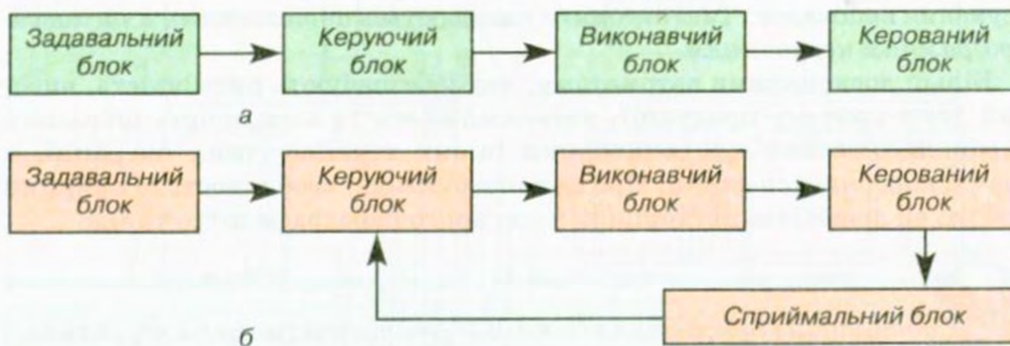
Мал. 30. Схеми автоматичної системи керування: а – з розімкнутим колом впливу; б – із замкнутим колом впливу
