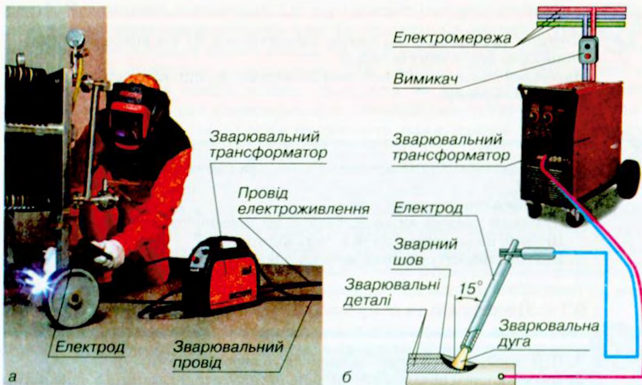
Мал. 56. Зварювання плавленням: а – загальний вигляд процесу зварювання; б – схема зварювання
