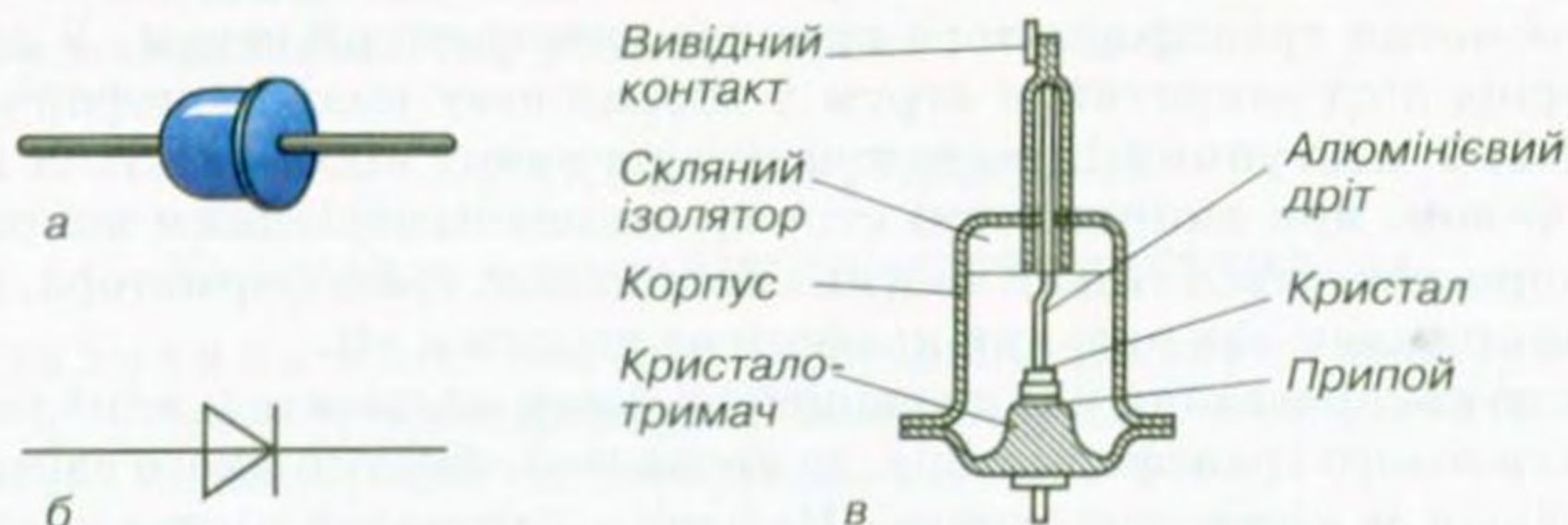
Мал. 72. Напівпровідниковий діод: а – зовнішній вигляд; б – умовне графічне позначення, в – будова
