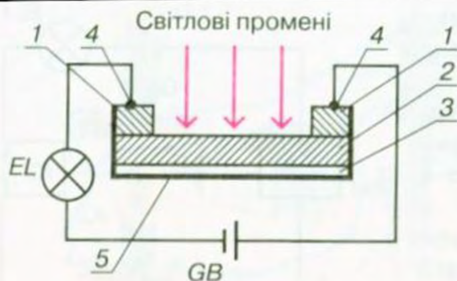
Мал. 82. Схема фоторезистора: 1 – електрод; 2 – світлочутливий матеріал; 3 – діелектрична пластина; 4 – електроди; 5 – корпус
