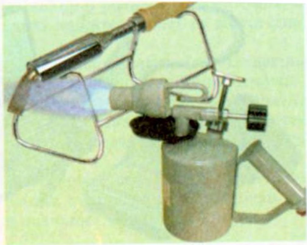
Мал. 51. Нагрівання паяльника бензиновою лампою
