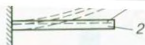
Мал. 75. Біметалева пластина: 1 – метал з меншим коефіцієнтом лінійного розширення; 2 – метал з більшим коефіцієнтом лінійного розширення
