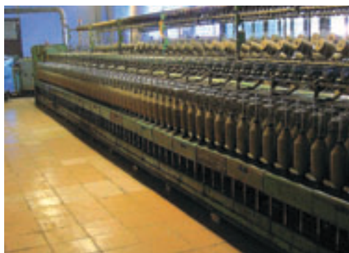
Рис. 13. Прядение льняной пряжи на современном льнопрядильном комбинате
