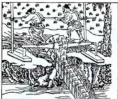
Водный насос с ножным при- водом. Подавал воду на поля. С рисунка XIV в.
