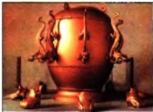
Китайский прибор для определения колебаний земной коры. Во время землетрясения из пасти металлических драконов в раскрытые ротики пустотелых лягушек, расположенных напротив, звонко падали шарики
